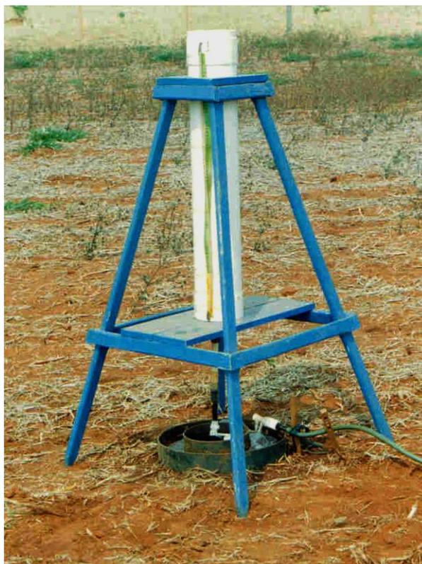
Figura 1. Detalhe dos anéis e da estrutura utilizada na determinação da taxa de infiltração estável e infiltração acumulada de água no solo.
