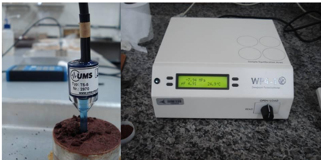
Figura 2. Ilustração da determinação do potencial da água no solo utilizando um minitensiômetro (em primeiro plano) e psicrometria (WP4-T) em segundo plano.
