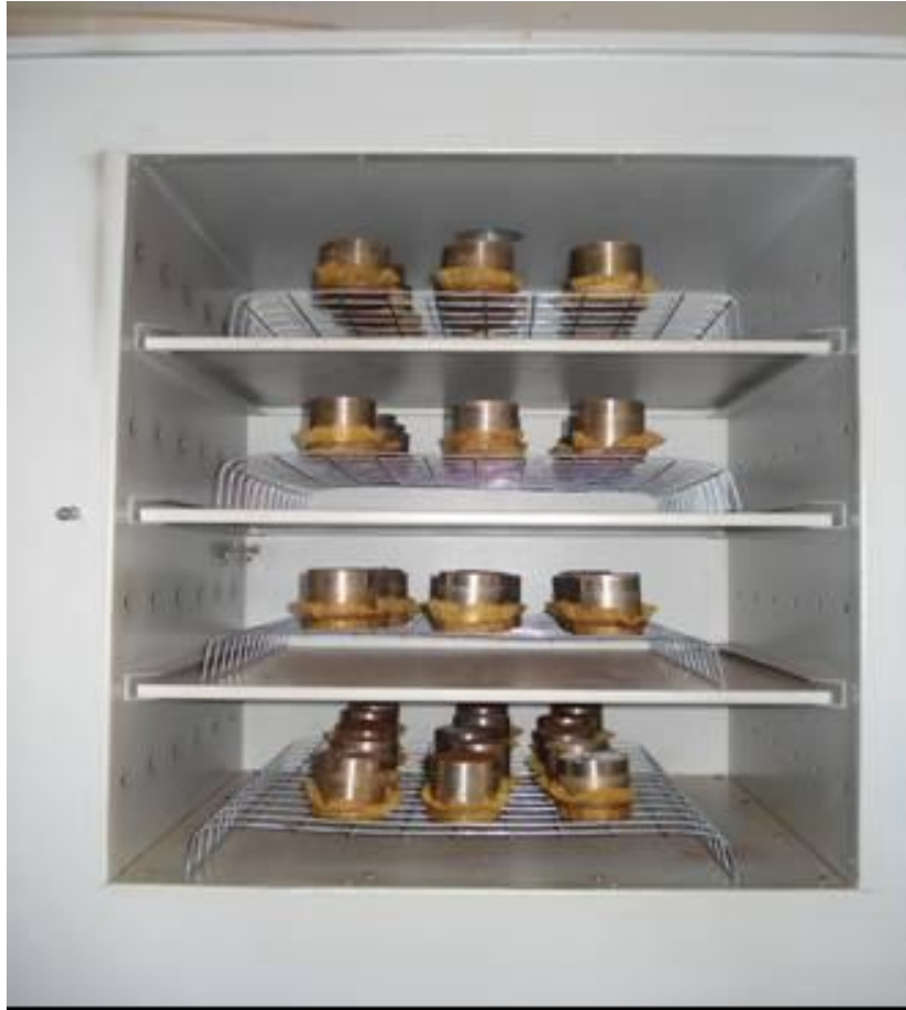
Figura 1. Visão frontal do sistema de secagem das amostras e dispositivo em tela metálica para acondicionamento das amostras em estufa com circulação forçada de ar.
