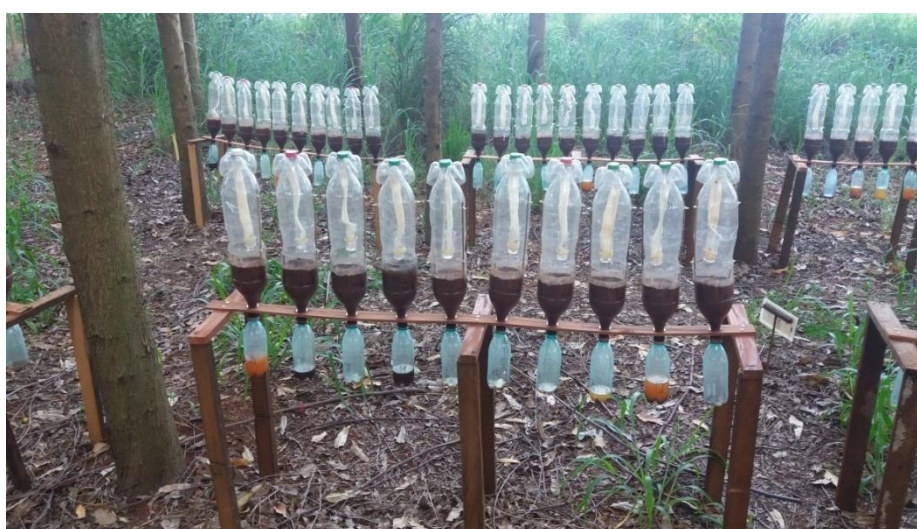
Figura 1.2 Conjunto de vasos construído com pet de 2 dm 3 com 1000 g de solo e acoplado a garrafa de 0,5 dm 3 para coleta do percolado. (Foto: o autor).
