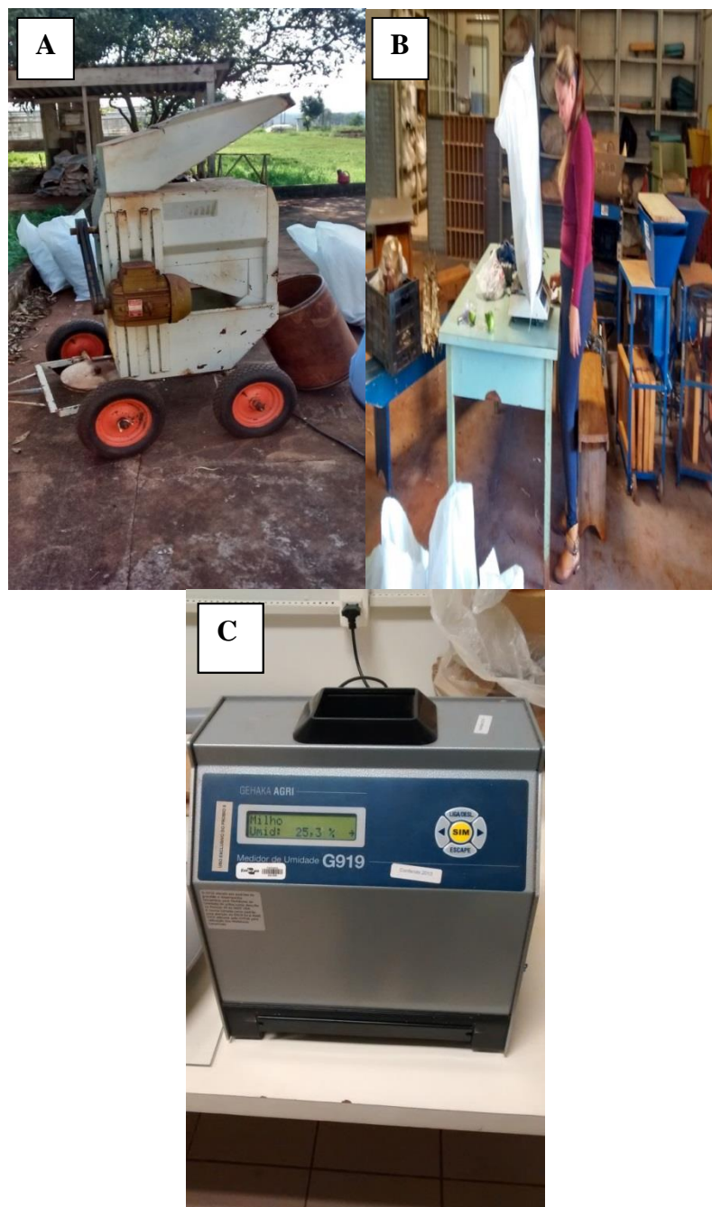
Figura 15. Processo para determinação da umidade de colheita do milho. (A) Trilhadeira; (B) pesagem da amostra em balança digital; (C) Medidor de umidade de grãos.
