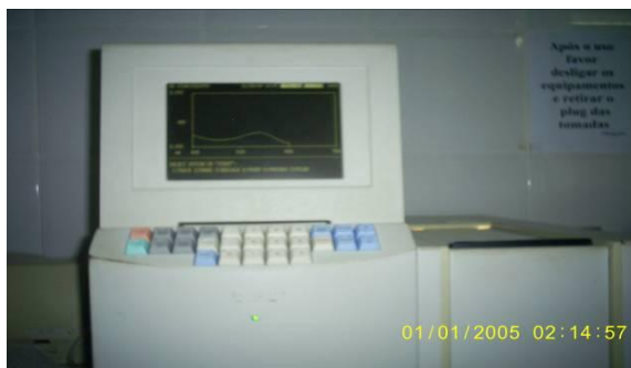
Figura 16 – Equipamento utilizado para as análises espectrofotométricas UV-Vis, Marca Hitachi 2001.
