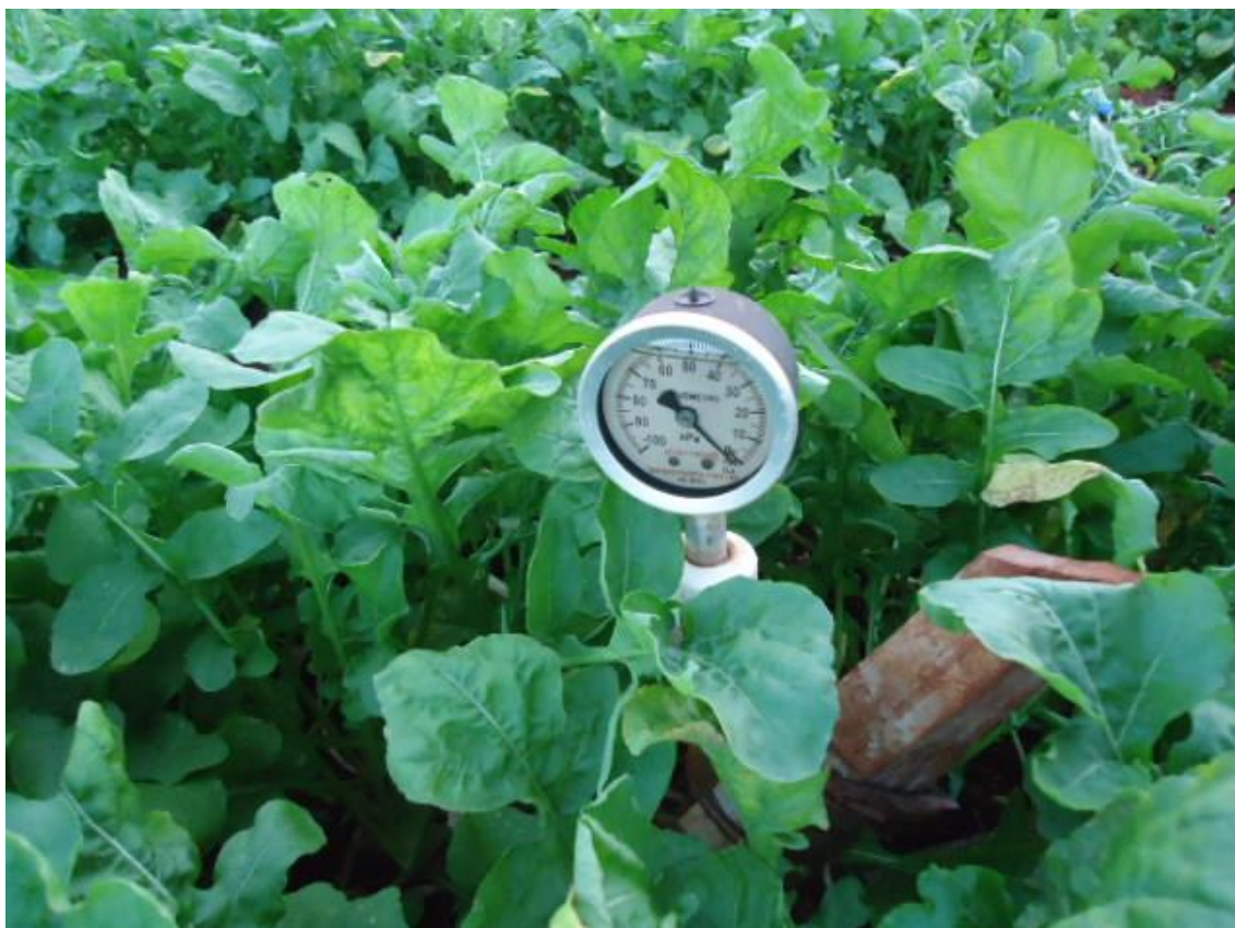
Figura 3. Tensiômetro analógico instalado na área experimental.
