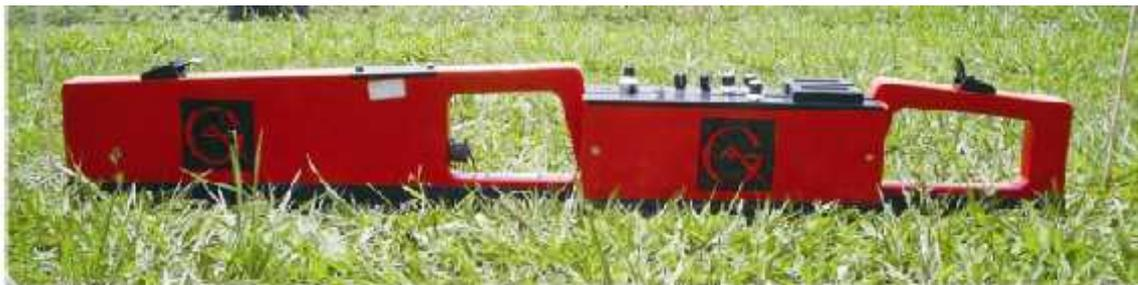
Figura 1. Equipamento Condutivimetro eletromagnético EM-38 (Geonics Ltd.).
