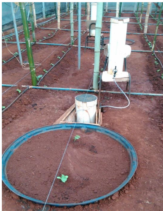
Figura 1. Lisímetro de lençol freático constante instalado na área experimental.
