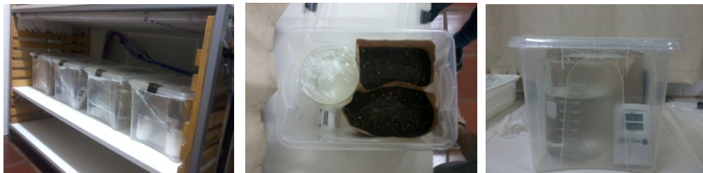
Figura 2A. Caixas para armazenamento das sementes de canola. Umidade relativa do ar interna controlada com solução de ácido sulfúrico e hidróxido de potássio.
