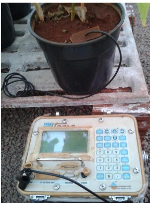
**Figura 4.** Leitura da constante dielétrica com aparelho TDR
