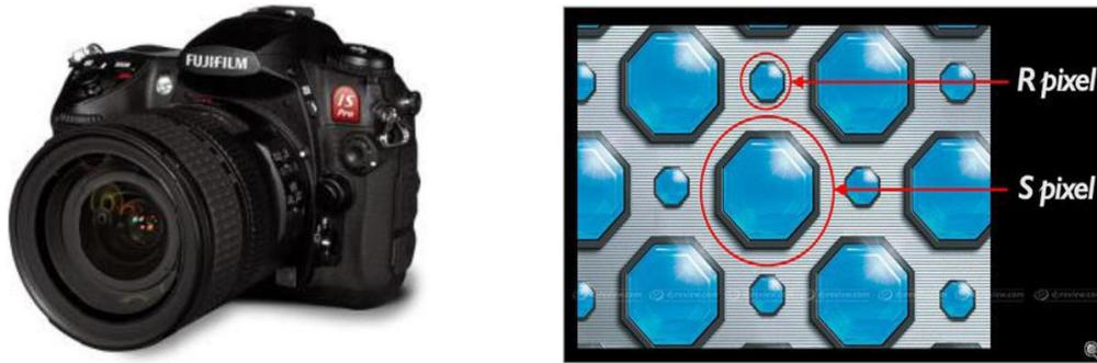
**Figura 5.** Câmera Fujifilm IS PRO e seu esquema do sensor super CCD SR PRO. Fonte: JOINSON, et al., 2007.
