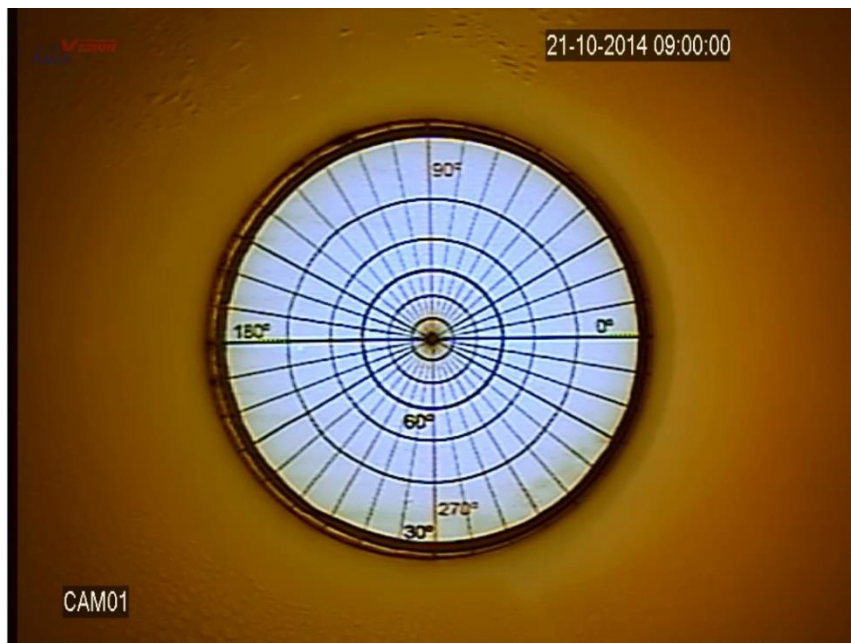
Figura 5.33 - Dia 21 de outubro de 2014, às 9 horas, com imagem do Sol (Elevação 42° Azimute 182°).
