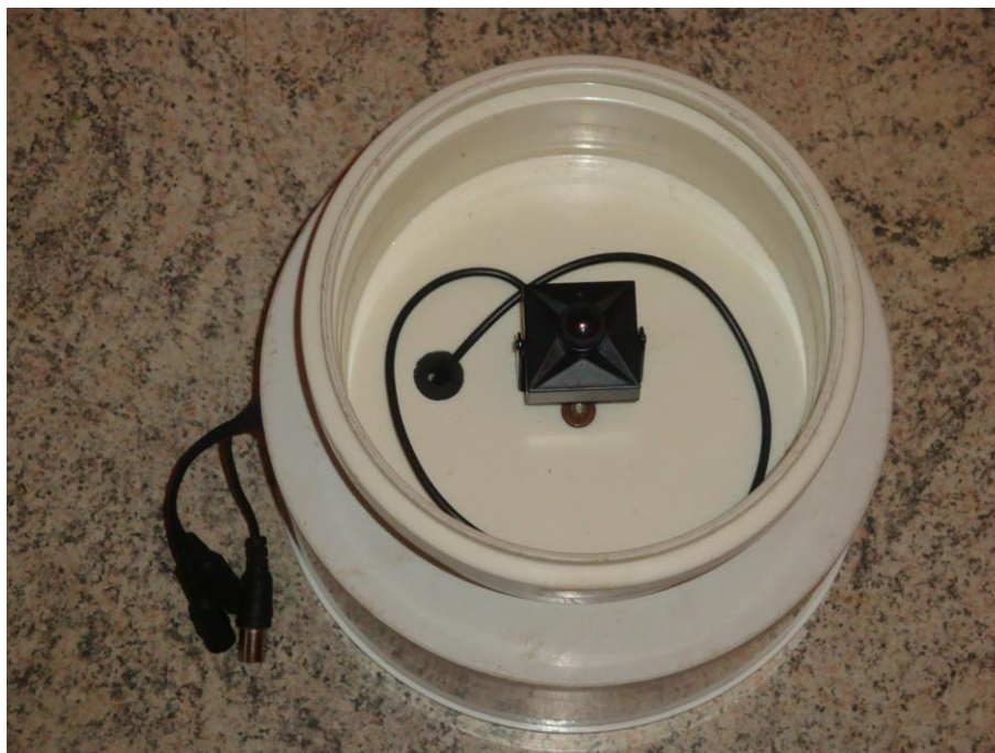
Figura 2.b - Câmera de filmagem parafusada no cap de PVC para 150mm e no cap de PVC para 200mm.
