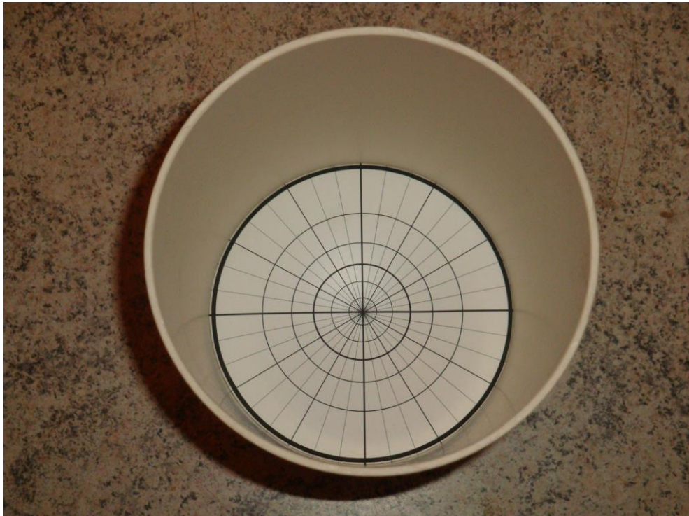
Figura 3 - Tubo de PVC de 150mm de diâmetro por 300mm de comprimento, com o gabarito de papel colado (vista inferior).
