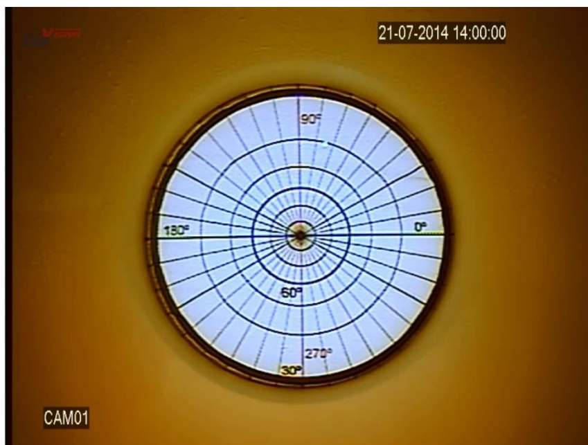
Figura 5.14 Dia 21 de julho de 2014 às 14 horas com imagem do Sol (Elevação 40° Azimute 74°).
