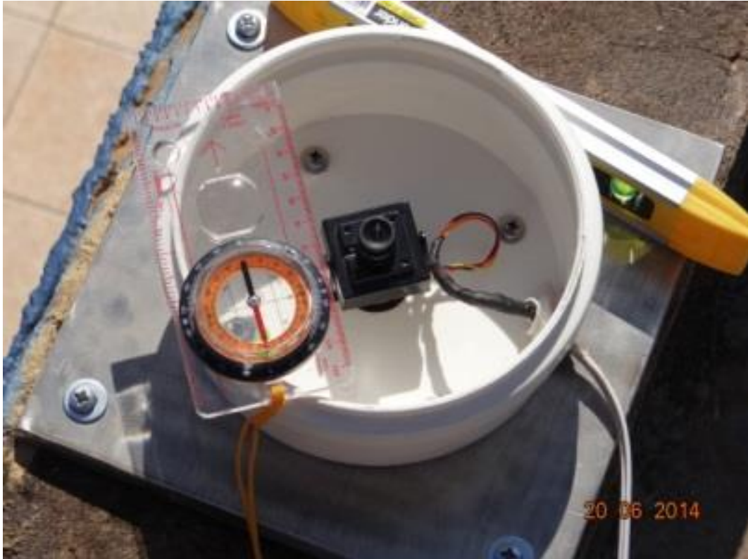
Figura 4.5 - Alinhamento da câmera (norte-sul) e da base de alumínio (horizontal).
