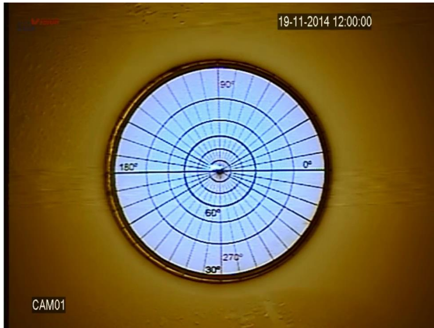
Figura 5.44 - Dia 19 de novembro de 2014, às 12 horas, com imagem do Sol (Elevação 85^{\circ} Azimute 140^{\circ} ).
