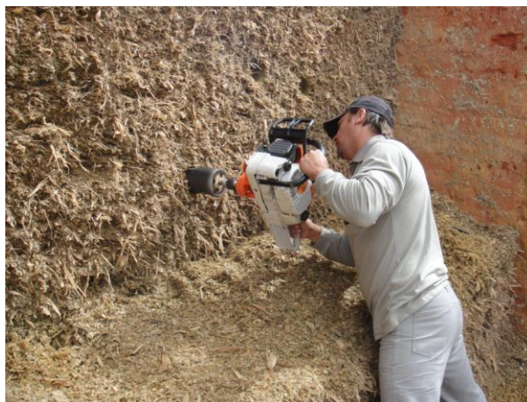
Figura 1 – Processo de amostragem com utilização do cilindro metálico acoplado à uma motosserra.
