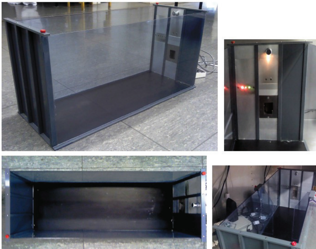
Figura 6: Vista lateral (acima à esquerda) e superior (abaixo à esquerda) da câmara de teste. Parede contendo o dispensador de pellets, lâmpada de iluminação difusa e três lâmpadas coloridas de sinalização - verde, amarela e vermelha (direita).
