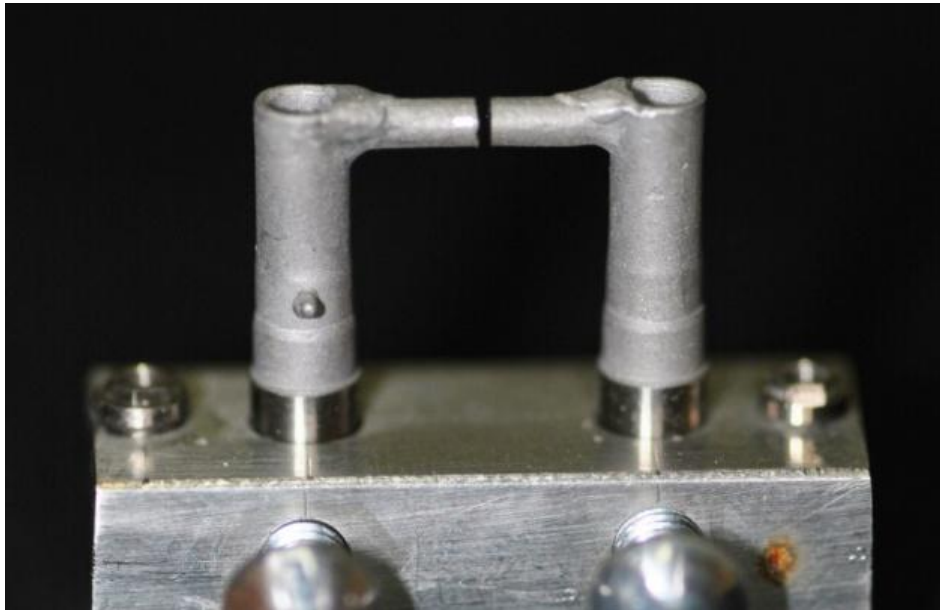
Figura 11. Adaptação dos corpos de prova no dispositivo de trabalho.
