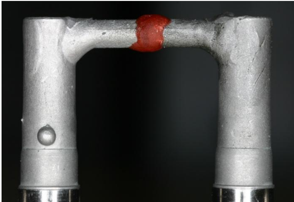
Figura 12. União com resina para solda por brasagem.
