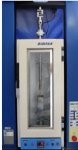
**Figura 3. Máquina de ensaio universal DL 1000 (EMIC), célula de carga modelo S com capacidade de 50N (5 kgf) e estufa (Biopar)**
