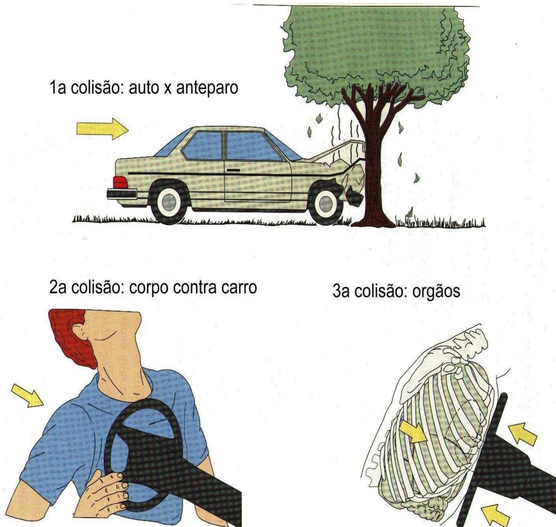
Figura 1- Sistema geral de proteção aos ocupantes de carro
