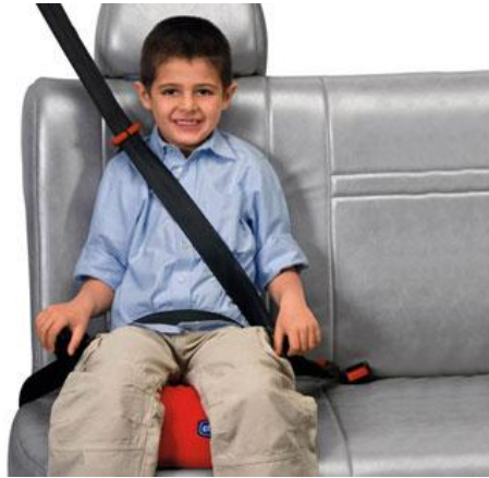
Figura 4 – Criança maior de quatro anos corretamente posicionada. Utilizando o cinto de segurança de três pontos associado ao assento elevatório sem encosto.
