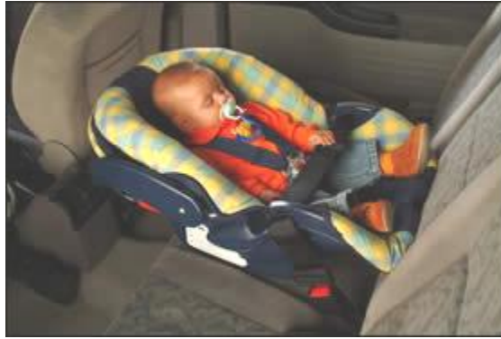
Figura 2 – Menor de 1 ano corretamente restrito em bebê conforto, voltado para trás, no banco traseiro do veículo, com clip peitoral sobre o esterno.
