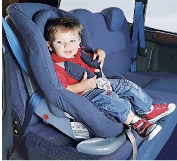
Figura 3 – Criança devidamente restrita voltada para frente, no banco traseiro do veículo, com clip peitoral sobre o esterno.
