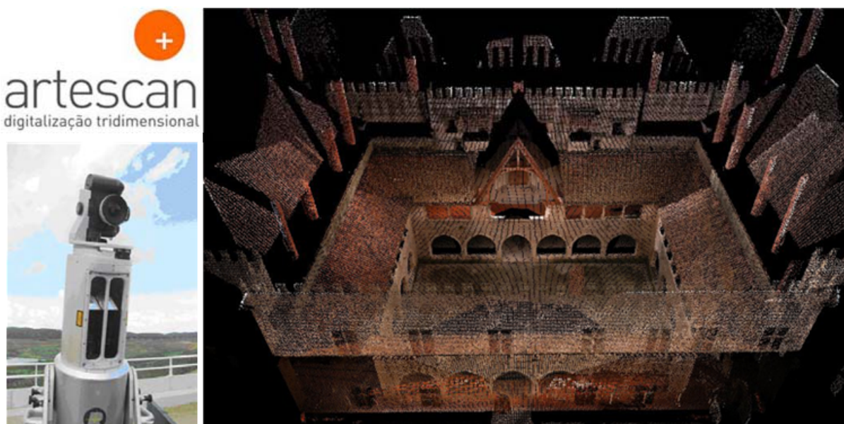
Figura 15 - Dados do Laser Range Scanner Riegl LMS Z-360I com informação de textura associada.
