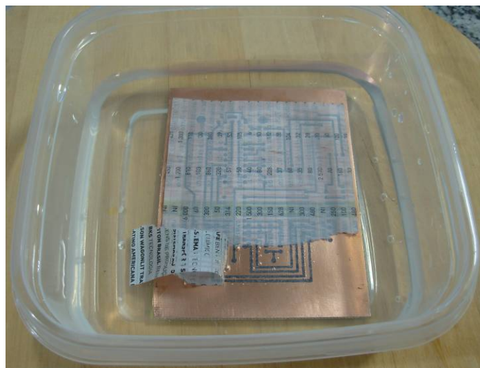
Figura 58: Processo de esfoliação da placa de circuito
