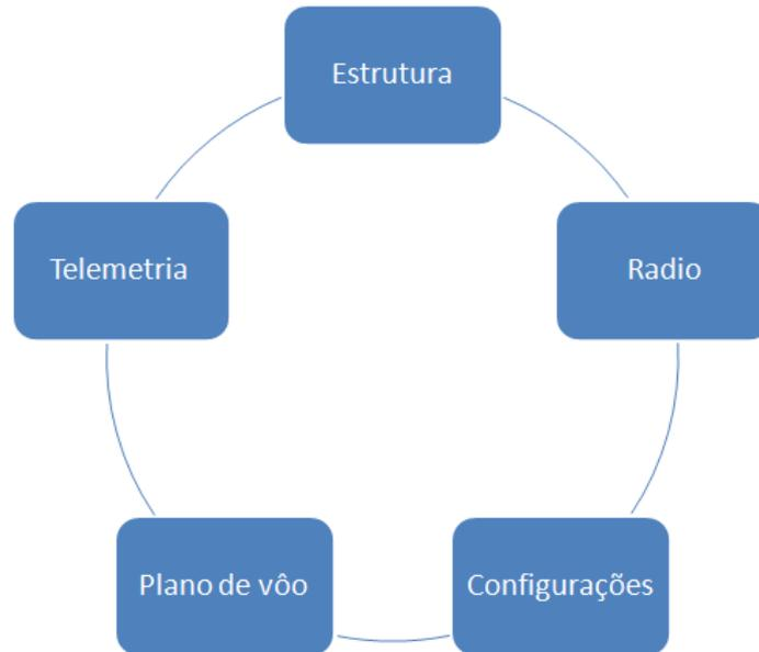
**Figura 45:** Arquivos de configuração piloto automático Paparazzi Yapa 2 (Coleman et al. 2012).
