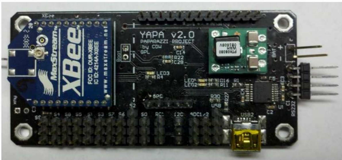
**Figura 44:** Placa do piloto automático Paparazzi Yapa 2.
