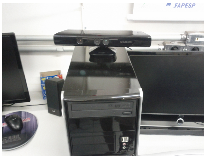
Figura 5.8: O Kinect ligado ao computador formando juntos o nó Kinect
