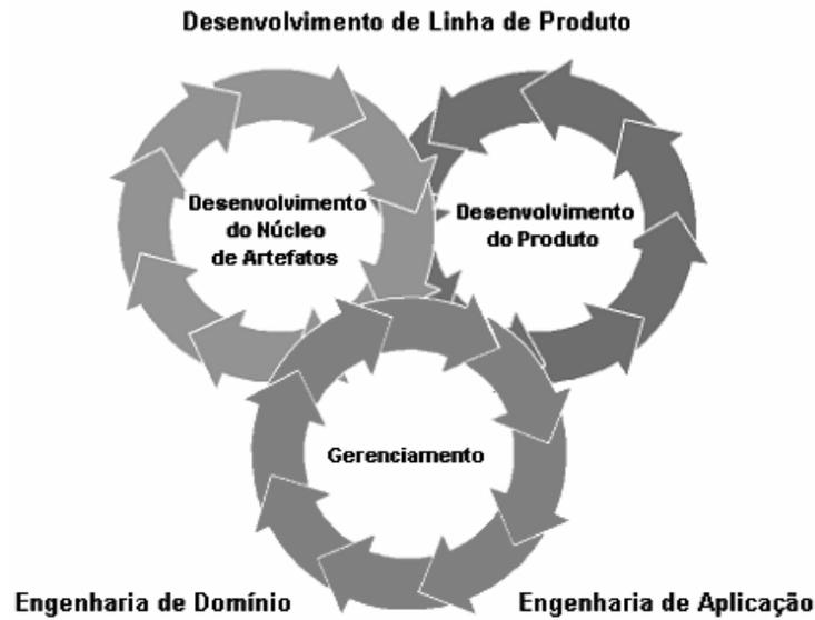
**Figura 3.2:** Atividades essenciais de Linha de Produto de Software (Adaptado). (Northrop e Clements, 2007)
