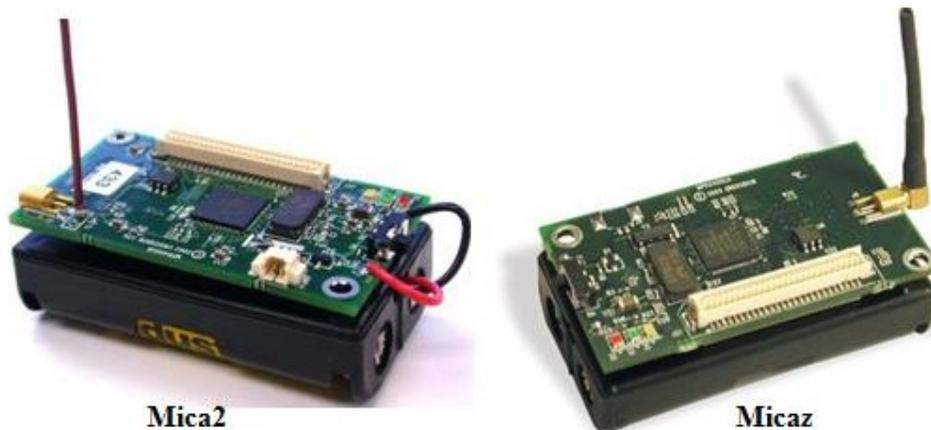
*Figura 2.7. Nós sensores da Crossbow*
