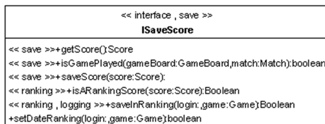
Figura 1 – Exemplo de Interface com Interesses associados usando estereótipos UML
