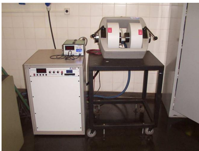
Figura 5.3 - Eletroímã utilizado na orientação das amostras para as medidas de índices de refração.
