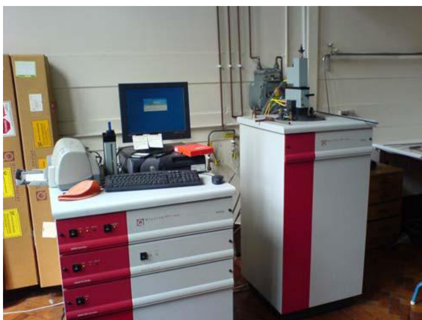
Figura 3.5: Magnetômetro SQUID usado neste trabalho do Instituto de Física da Matéria Condensada da Technische Universität Braunschweig .
