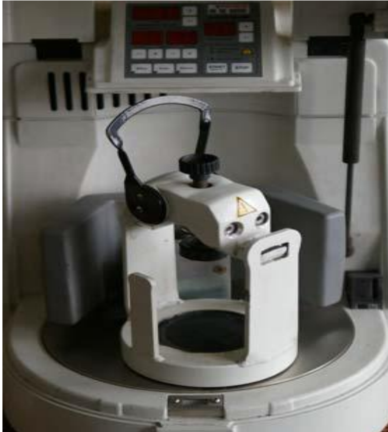
Figura 3.1: Moinho planetário Pulverisette 6 usado neste trabalho.
