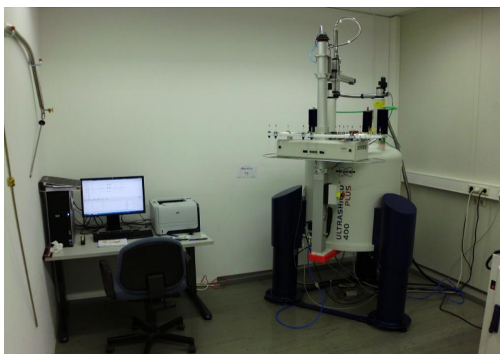
Figura 3.6: Espectrômetro de ressonância magnética nuclear (RMN) do Instituto de Físico Química e Eletroquímica da Leibniz Hannover Universität
