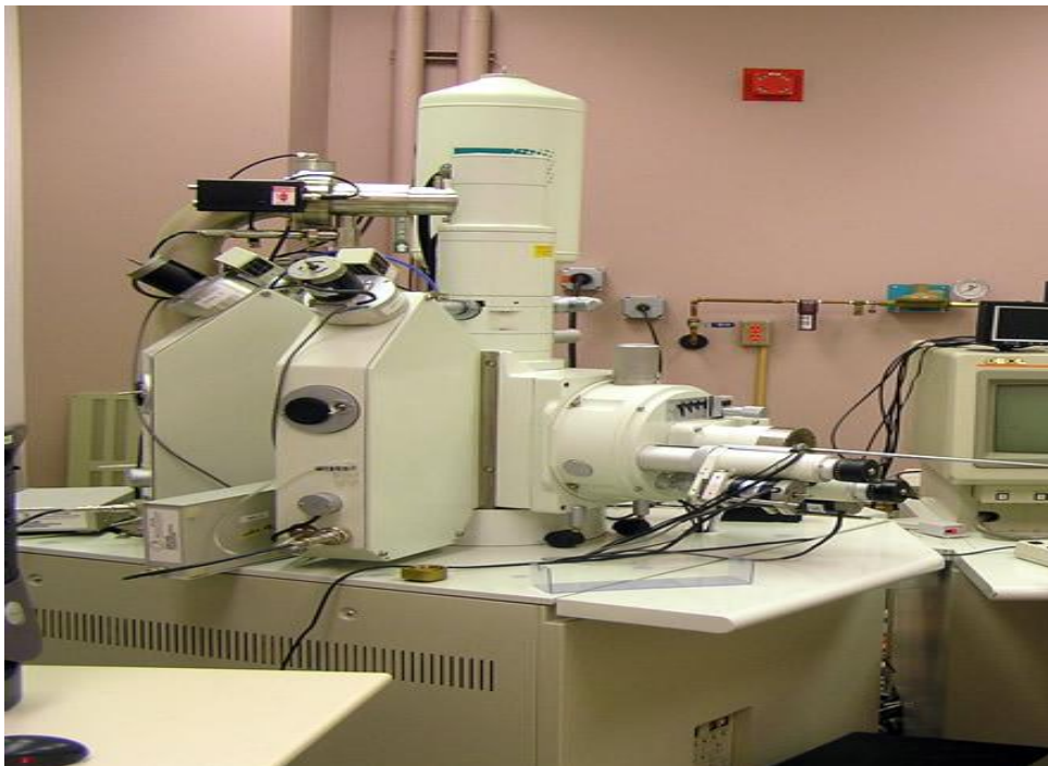
Figura 3.2: Espectrômetro de energia dispersiva de raios X (EDXs) do Instituto de Física e Química Teórica da Technische Universität Braunschweig .
