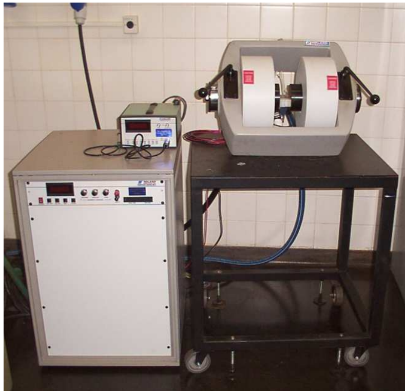
Figura 3.18: Eletroímã, utilizado na orientação das amostras.
