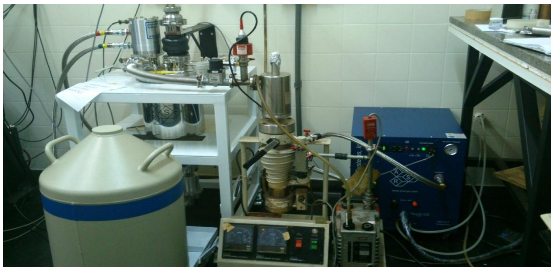
Figura 31: Criostato de ciclo fechado, utilizado nas medidas de Espectroscopia Mössbauer.
