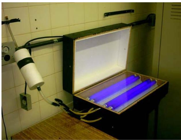
**Figura 3.4**–Câmara de polimerização UV desenvolvida no laboratório de CL doDFI/UEM para a produção de filmes de PDLC.
