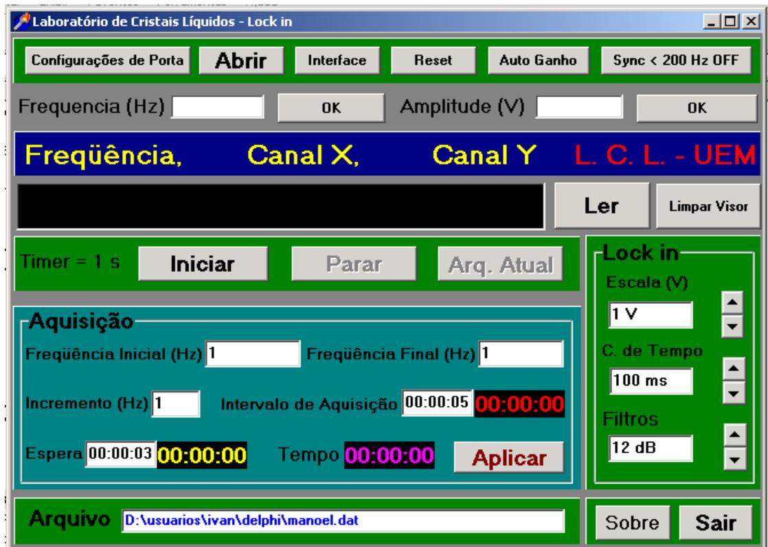
**Figura 3.12**-Programa de aquisição de dados desenvolvido para o amplificador Lock-in.
