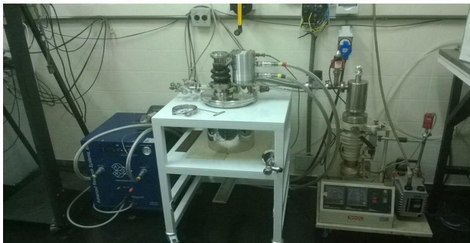
Figura 22 - Criostato utilizado na realização de medidas em baixas temperaturas
