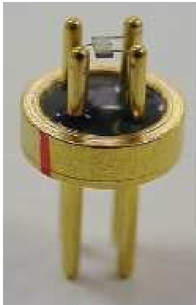
Figura 2.6: Sensor de estado sólido usado para detectar mais de 100 gases tóxicos, desenvolvido pelo IST em 1972 (CHOU, 2000).
