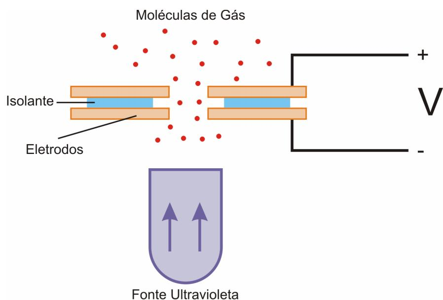
**Figura 2.4** - Configuração típica de um detector de fotionização.
