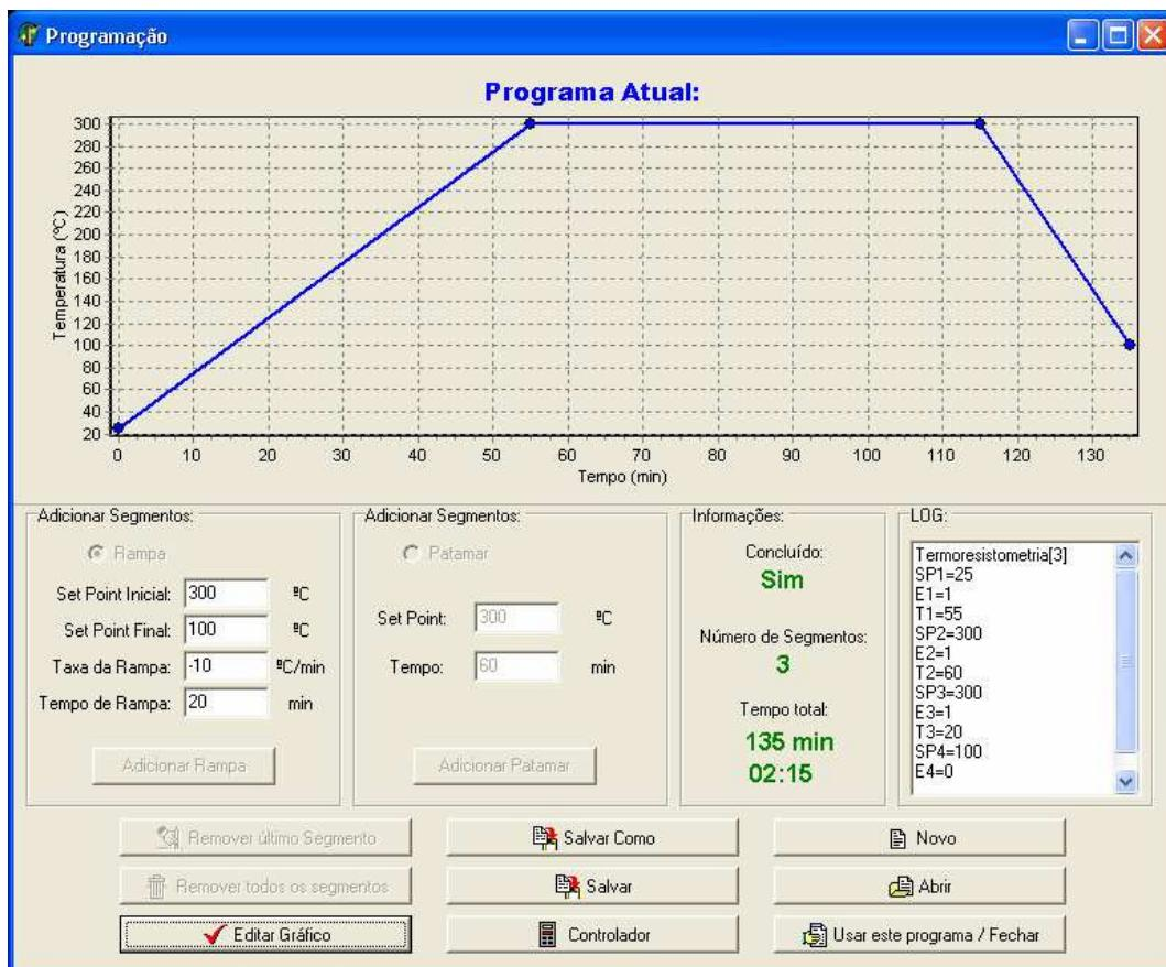
**Figura 3.9** - Janela da programação do controlador de temperatura.
