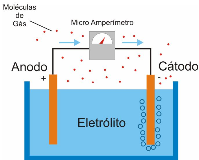
**Figura 2.2** - Esquema do mecanismo de oxidação e redução.
