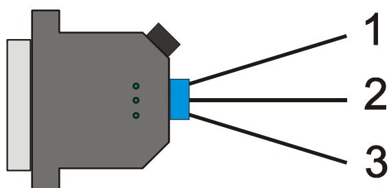
**Figura 3.3 – Adaptador utilizado na conexão entre o controlador e computador.**
