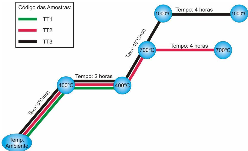
**Figura 3.13 - Tratamento térmico dos pós liofilizados.**
