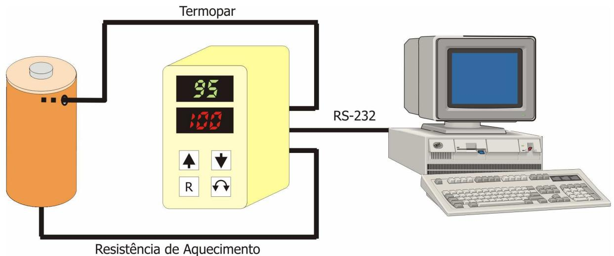
**Figura 3.2 - Conexões do controlador de temperatura.**
