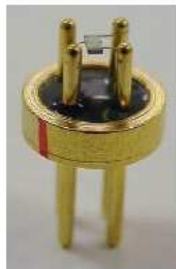
**Figura 2.5** - Sensor de estado sólido usado para detectar mais de 100 gases tóxicos (CHOU, 2000).
