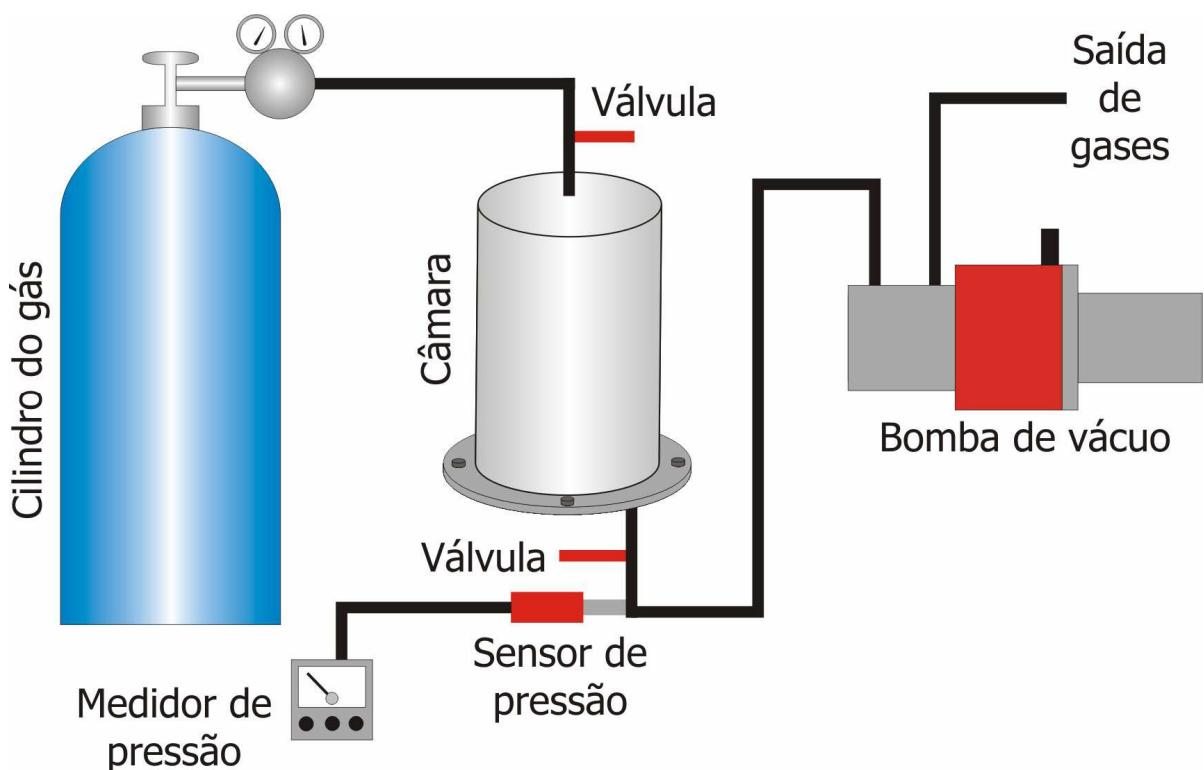
**Figura 3.7 - Conexões Gasosas:** entrada e saída de gases.
