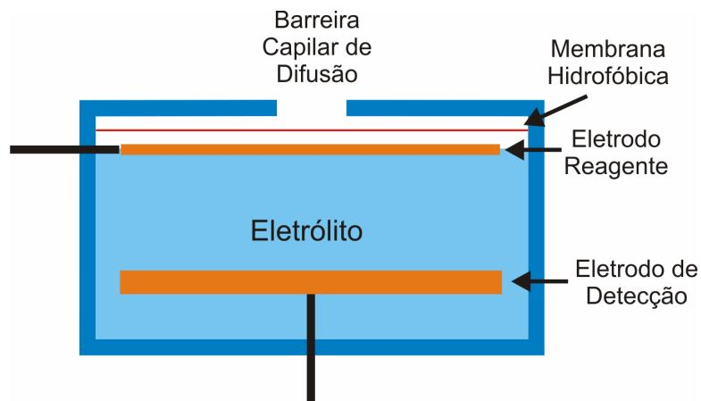
**Figura 2.1** - Esquema de um sensor eletroquímico típico.
