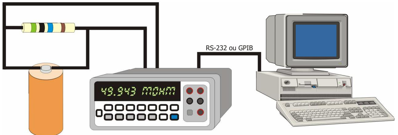
**Figura 3.4** - Resistência elétrica em paralelo com a amostra, e conexão entre o computador e o multímetro.
