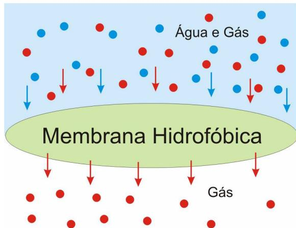
**Figura 2.3 - Membrana hidrofóbica.**
