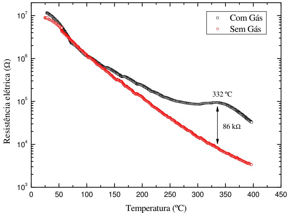
**Figura 4.6** – Comparaçāo de medidas de TER da amostra TT1. Em vermelho medida realizada sem gás em ar atmosférico ( $P \approx 1$  atm); em preto medida realizada com gás sob baixa pressão ( $P < 1$  atm).
