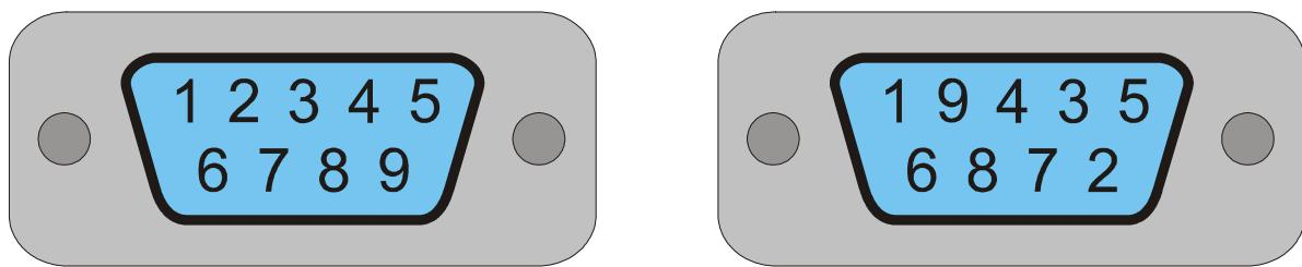
**Figura 3.5 – Esquematização dos pinos do cabo do multímetro.**
