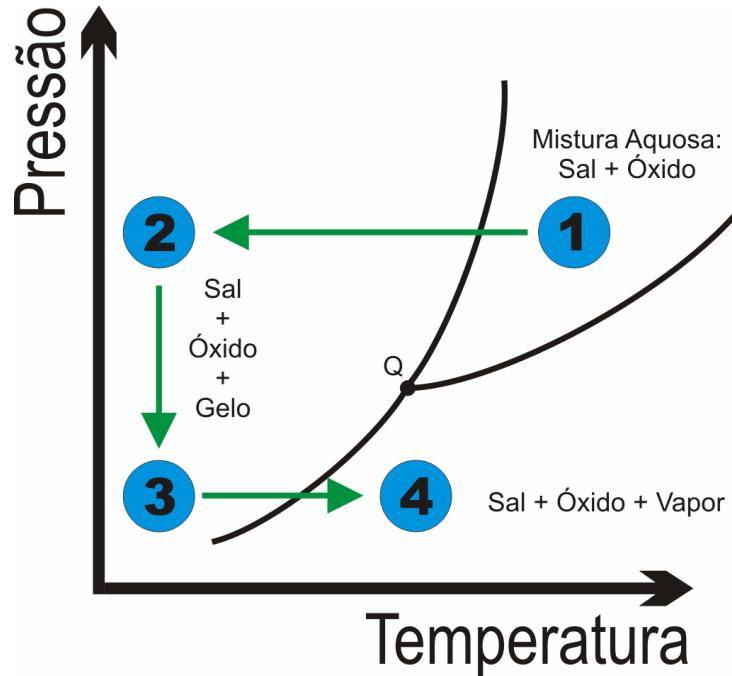
**Figura 3.12** - Liofilização em um diagrama de fases esquemático de uma solução aquosa.
