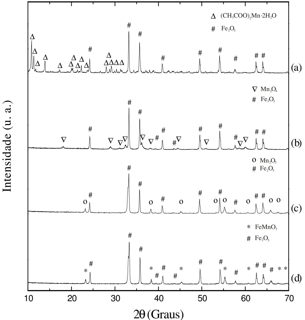
**Figura 4.1** – Difratogramas: a) amostra liofilizada; b) amostra TT1; c) amostra TT2; d) amostra TT3.
