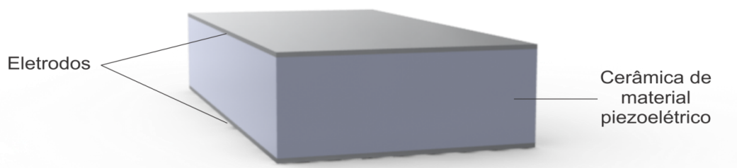
Figura 1. 3: Dois eletrodos depositados sobre a cerâmica de material piezoelétrico.
