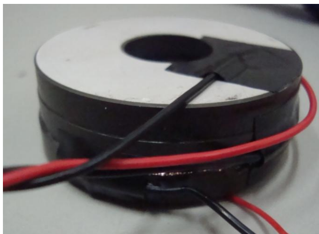
Figura 4. 7: TP 1.2 I C V - Transformador Piezoelétrico PZT4 - 1:2 Isolado com Vidro, duas camadas como atuador e uma como transdutor, Tipo Radial.
