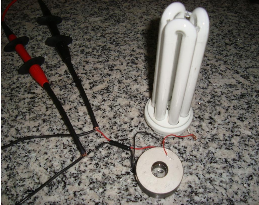
Figura 5. 42: TP PZT4 1:2 aplicado a um reator de uma lâmpada fluorescente de 20W – Tipo 1.
