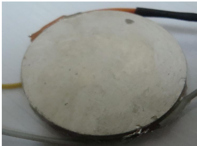
Figura 4. 2: TP 1.1 I C V – Transformador Piezoelétrico PZT5A 1:2 isolado com vidro e eletrodo em paralelo.
