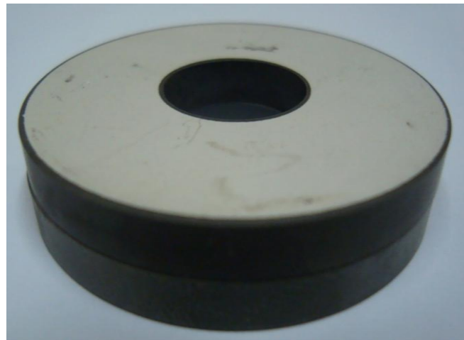
Figura 4. 6: Elementos de PZT4 com 45 mm de diâmetro externo, 15 mm diâmetro interno e 5 mm espessura. Eletrodo Paralelo, também conhecido como Disc with Hole.
