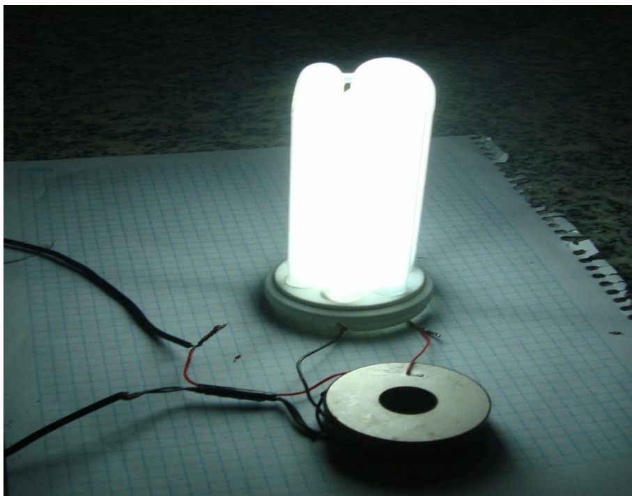
Figura 5. 43: Lâmpada fluorescente compacta de 20W acesa pelo TP PZT4 1:2 aplicado a um reator.
