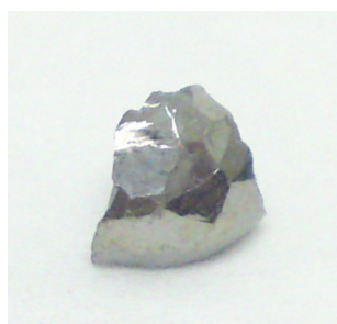
Figura 3.3. Liga magnetocalórica Gd_{5,09}Si_{2,03}Ge_{1,88} usada para o estudo na forma de pó
