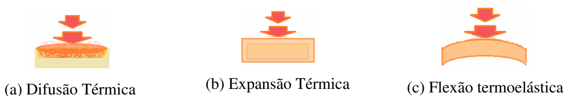
Figura 2.5. Mecanismos para a geração do efeito fotoacústico: (a) pistão térmico da camada de gás adjacente, (b) dilatação térmica da amostra e (c) dilatação não-uniforme devido à ocorrência de um gradiente de temperatura perpendicular ao plano da amostra
