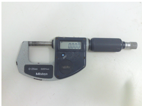
Figura 3.7. Micrômetro utilizado para medir a espessura dos bastidores
