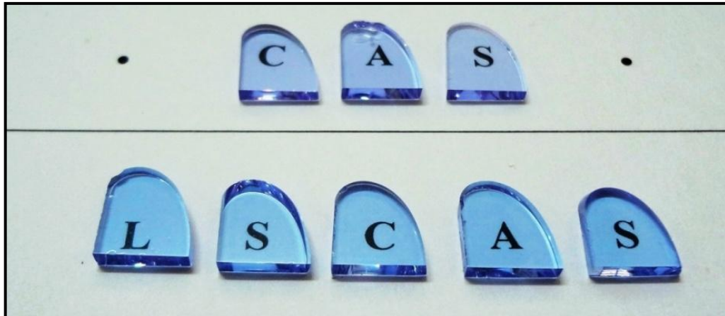
Figura 3.2 - Foto das amostras no estado vítreo (sem tratamento térmico) após corte e polimento.
