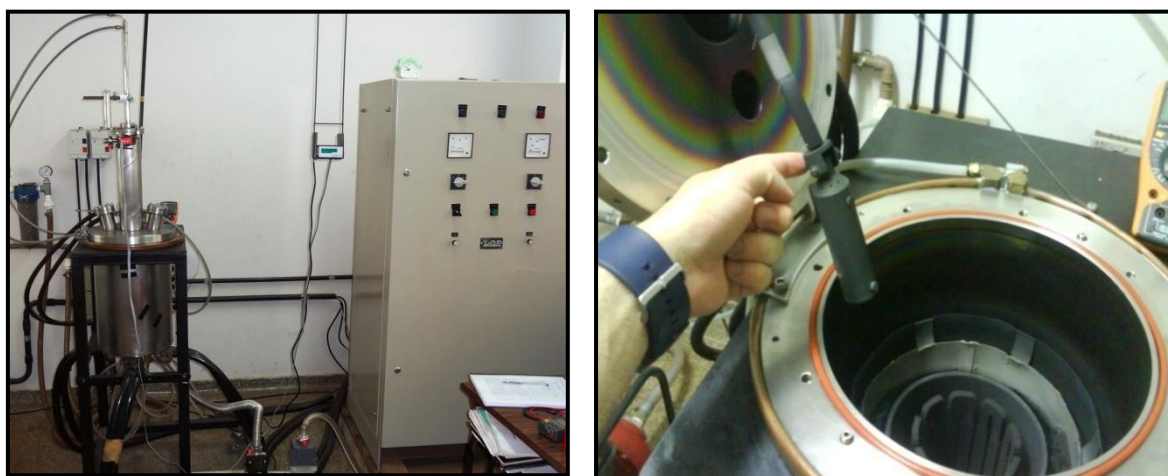
Figura 3.1 – À esquerda, Forno de fusão a vácuo. À esquerda, parte superior evidenciando o cadinho de grafite onde é feito o acondicionamento dos reagentes para preparação das amostras.
