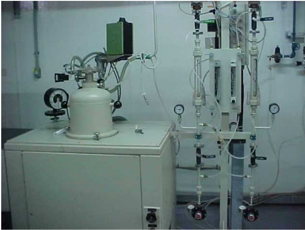
Figura 3.2(a): Forno Degussa utilizado nas sinterizações das amostras \text{UO}_2\text{-X\%Gd}_2\text{O}_3 .
