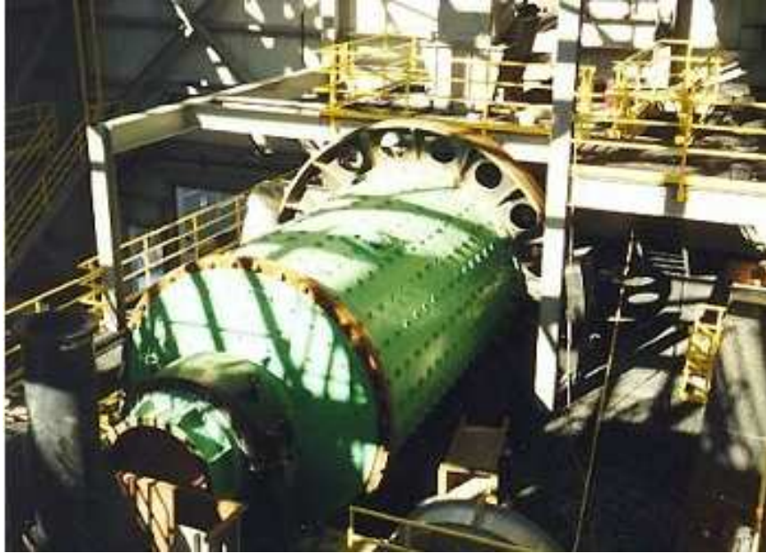
Figura 2.17: Moinho de bolas tipo “canhão de bolas” para grande capacidade de carga [39].
