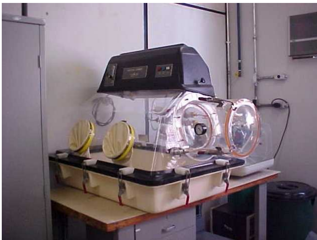
Figura 3.1: Glove-box dentro da qual se procedeu às moagens. O sistema permite o controle da atmosfera interna.
