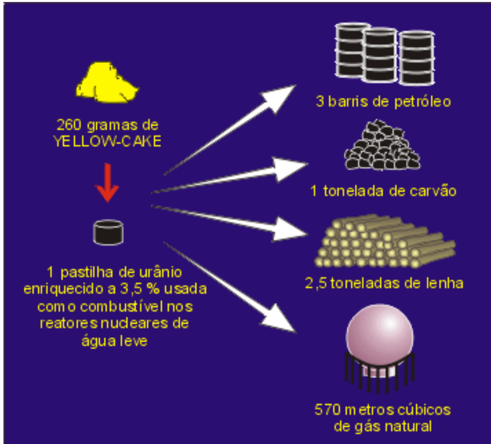
Figura 1.1: Equivalência energética de uma pastilha de urânio sinterizado, onde a urânio foi enriquecida a 3,5%, relativamente a outras fontes de energia [2].
