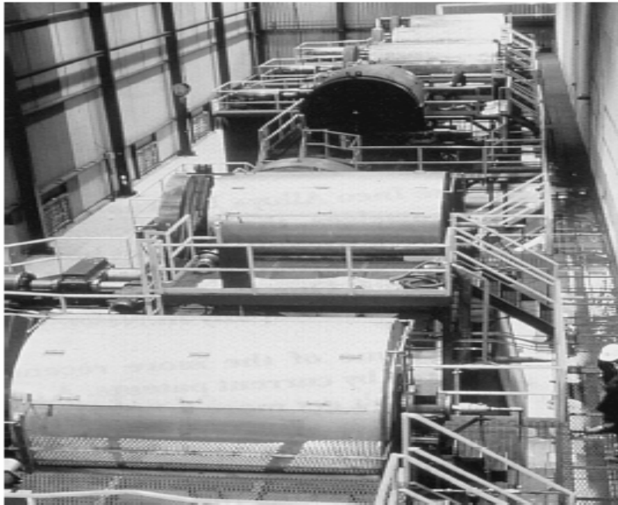
Figura 2.19: Moinho de bolas comercial usado para a produção de MA [29].
