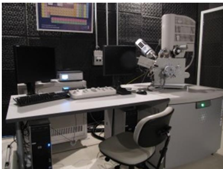
Fig. 4.8.1: Microscópio Eletrônico de Varredura de alta resolução SEM-FEG HR (FEI Inspect F50), pertencente ao LNNano.
