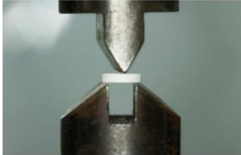
Fig. 4.8.2: Acessório para fraturar amostras, para análise de fratura e superfície no MEV imagem, retirada da referência [9].
