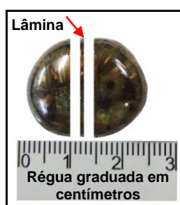
Figura 3.6 - Botão e lâmina seccionados por corte metalográfico das amostras como-fundidas e tratadas.
