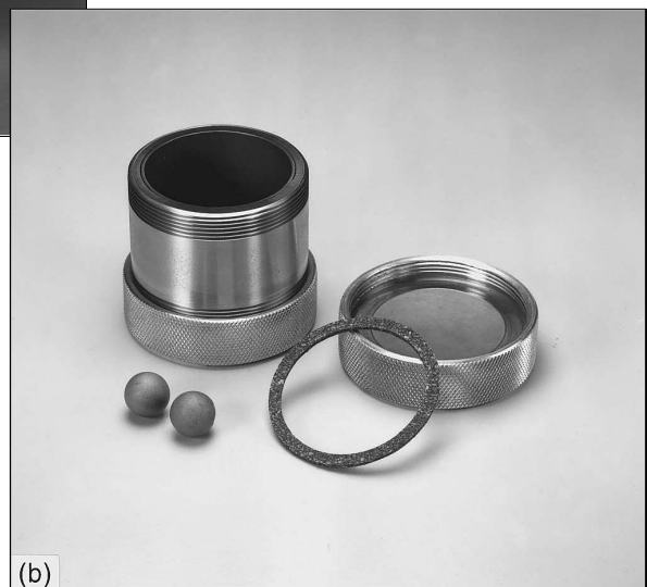
Fig. 2.6 (a) Moinho Spex 8000. (b) Conjunto de carbeto de tungstênio: vaso de moagem, tampa, vedação e bolas.
