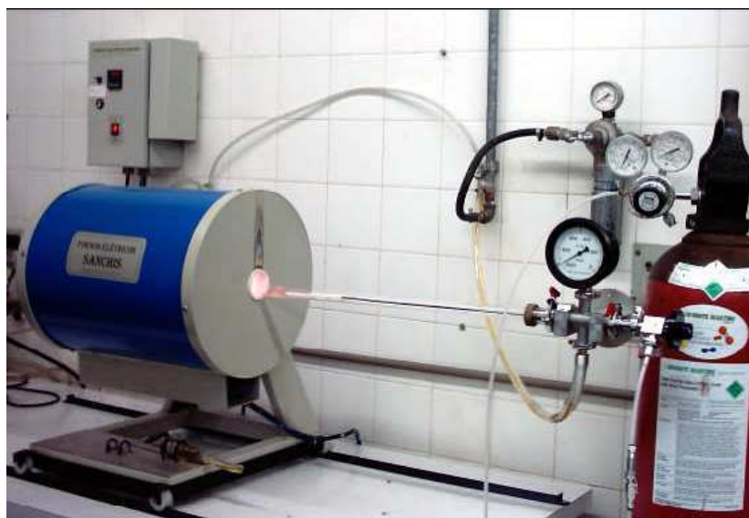
Figura 3.5 – Forno tubular utilizado para o tratamento térmico.
