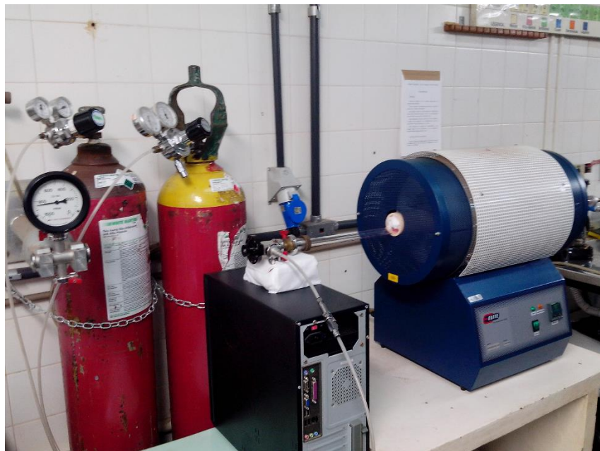
Figura 3.4- Forno tubular utilizado no preparo das amostras. Na mesma figura é possível ver o cilindro de hidrogênio utilizado e o aparato de fluxo contínuo.
