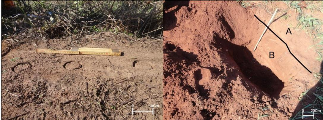
As amostras deformadas e indeformadas coletadas no trabalho de campo foram levadas para o laboratório, onde foram realizados os ensaios de absorção de água (S) e perda de massa por imersão (P), que fundamentam o cálculo da erodibilidade, de granulometria, que permite a determinação da textura dos solos para que se gerassem os índices relativos ao potencial erosivo para a bacia hidrográfica do rio Ligeiro.
