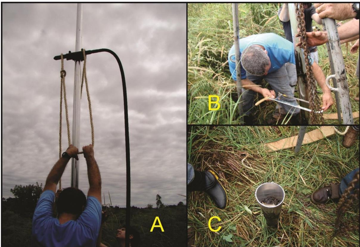
Figura 21: Sondagem com uso do *vidro-core* na planície do rio Água dos Papagaios.
