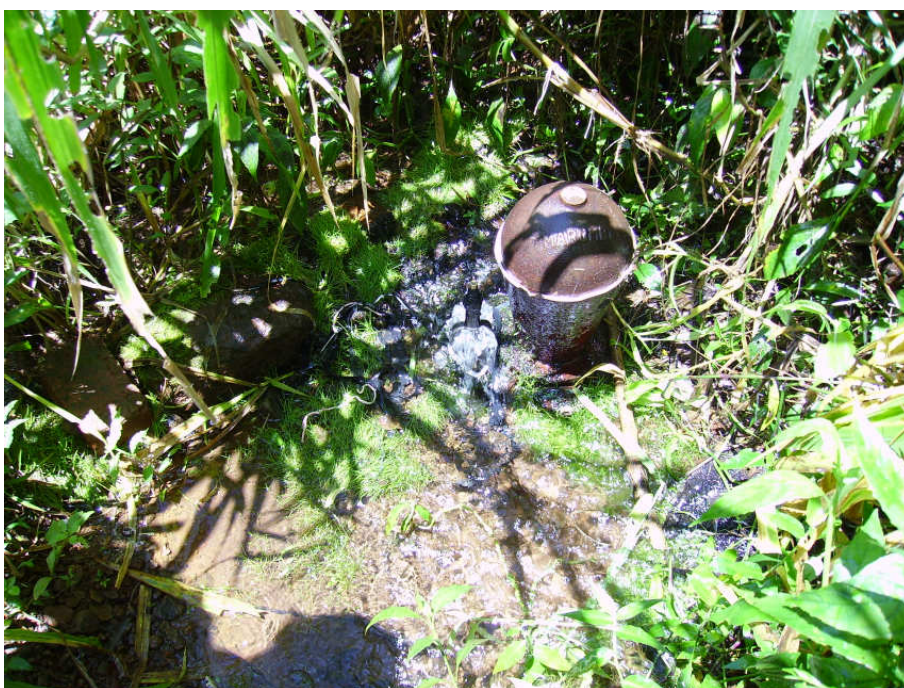
Foto 71 - No mesmo local, citado anteriormente, um barulho como que de um martelo batendo em ferro chama a atenção. Ao se seguir o som, foi encontrado, cravado no solo, um mecanismo chamado pelo Cabo Leme de "burrinho" que bombeia a água, em pleno funcionamento, todo envolto de vegetação, jorrando água e denunciando o êxodo rural.
