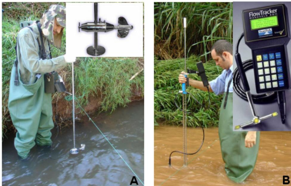
Figura 11. Demonstração de utilização e modelo dos aparelhos. (A) Micro-molinete e (B) Flow Track.
