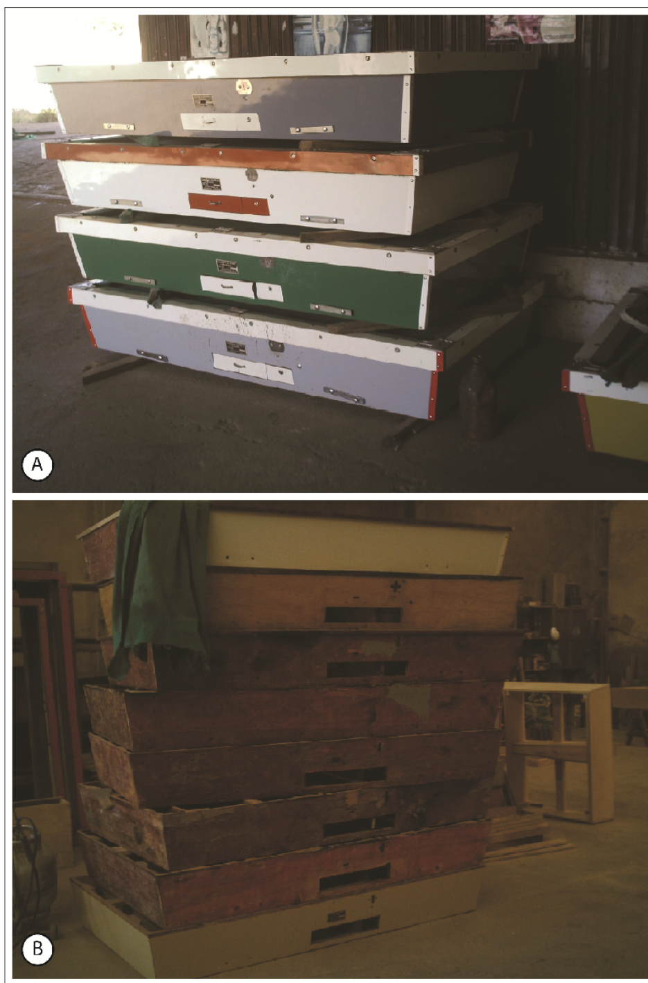
Figura 05. Vista parcial de mesas para serem reformadas. Foto A: mesas com a parte lateral (laminado) danificada. Foto B: mesas que serão reformadas desde a base. Por se tratar de uma produção similar ao artesanal, cada mesa para bilhar acaba tendo pequenas diferenças em relação ao tamanho e encaixe das peças. Sendo assim, não pode ocorrer a troca de seus componentes (quadro, ardósia e tabelas principalmente). Para evitar tal problema, essas peças são numeradas quando a mesa é desmontada.
