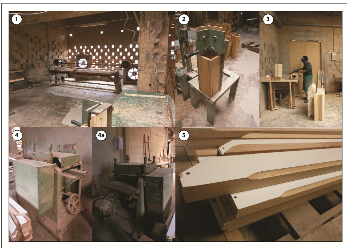
Figura 22: Visão parcial do Setor de fabricação dos pés e polimento de peças da mesa. Na foto 1 observa-se uma máquina de lixar e ao fundo chama-se a atenção para a furação nas paredes e aos dois exaustores que retiram o pó do ambiente. Na foto 2 tem-se um equipamento criado pelo empresário para auxiliar na furação dos pés da mesa, funciona como um gabarito de furação. Na foto 3 observa-se um funcionário trabalhando algumas peças. Na foto 4 tem-se uma máquina adaptada para o prensamento da tabela junto à fórmica (foto 5), peças denominadas tabela. Foto: VEIGA, L. A., 2013. Fonte: Levantamentos de campo, 2013.
