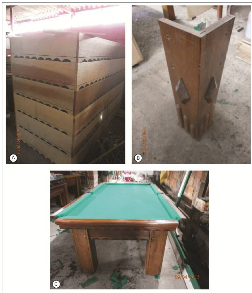
Figura 12: Vista parcial das mesas para bilhar finalizadas no barracão da empresa Bilhar Bola Verde localizada em Belo Horizonte. Base das mesas (foto A); peça de sustentação da mesa -os pés- na (foto B) e mesa pronta para ser entregue (foto C).
