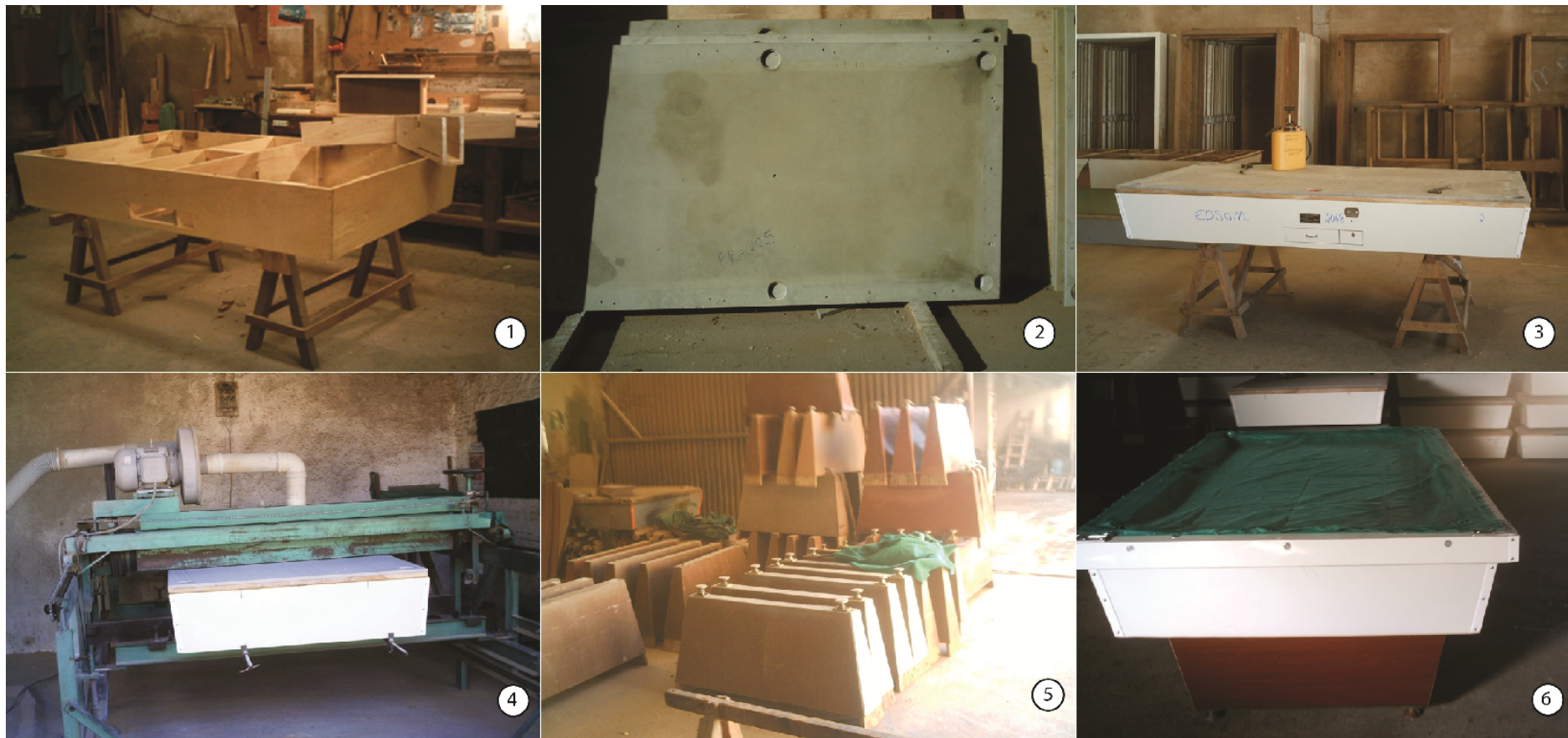
Figura 04. Principais etapas de produção das mesas para bilhar em grande parte das fábricas do Centro-Sul brasileiro. 1- base da mesa feita em madeira; 2- ardósia que será utilizada para compor a mesa; 3- a base revestida com a fórmica e com a ardósia fixada na parte superior e ao fundo algumas peças que irão compor a mesa, denominadas 'quadros'; 4- equipamento para realizar o acabamento final na ardósia (lixar); 5- peças denominadas 'pés' da mesa para bilhar; 6- mesa finalizada recoberta na parte superior por um tecido.
