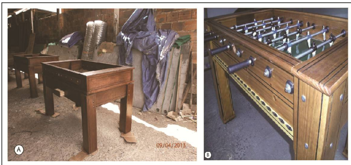
Figura 13: Vista parcial das mesas para pebolim finalizadas no barracão da Bilhar Bola Verde de Belo Horizonte. Mesas recebendo os acabamentos finais (foto A) e mesa pronta para ser entregue (foto B).
