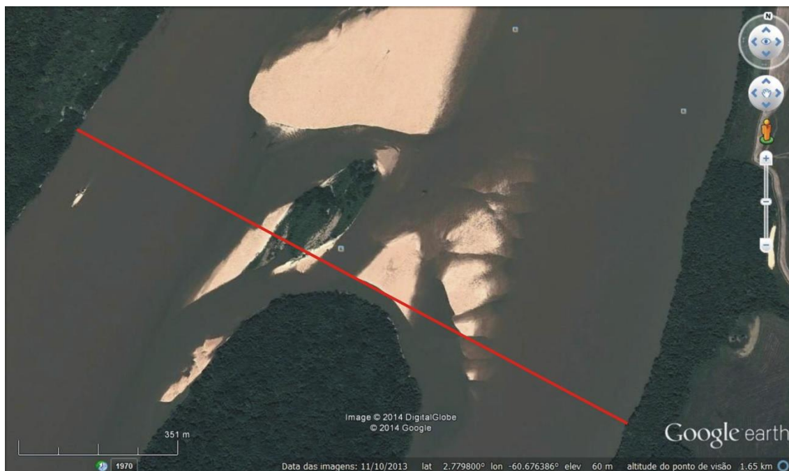
Figura 5.29: Perfil transversal (linha vermelha) a montante da ilha de São Lourenço (Perfil E, Figura 5.28). Mostra o avanço da barra em direção à ilha de São Lourenço (jusante), durante a transição do período de cheias para a vazante, avançando sobre um canal que flui entre os dois depósitos sedimentares (Fonte GeoEye, 2013)
