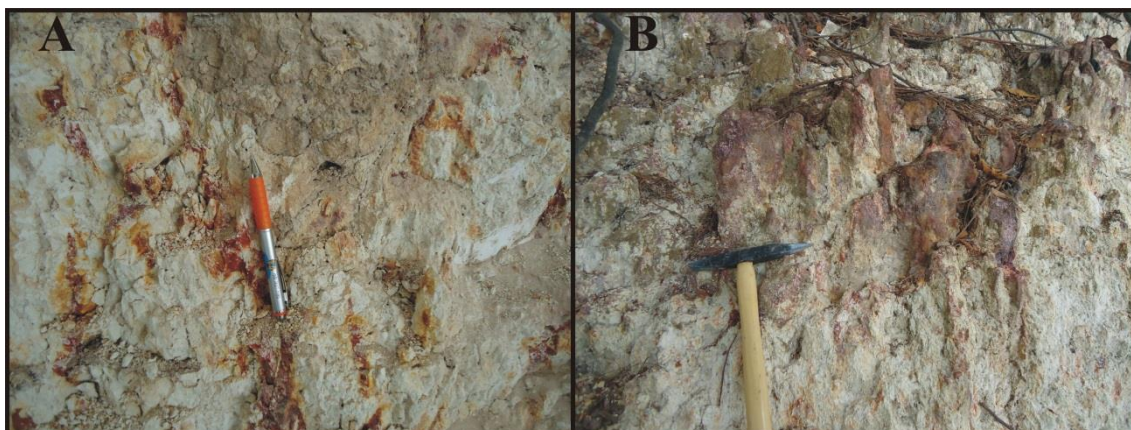
Figura 5.14: Fácies associadas à Formação Boa Vista. Compreende sedimentos silto/argilosos ( Fm ) a areno/argilosos ( Sm ) com cor predominantemente creme, mosqueados e com ocorrência de concreções ferruginosas. A imagem “A” mostra fácies silto/argilosa ( Fm ) mosqueada com nódulos ferruginosos. Na figura “B” é apresentada fácies Sm com a presença de concreções lateríticas posicionada próximo a base do perfil
