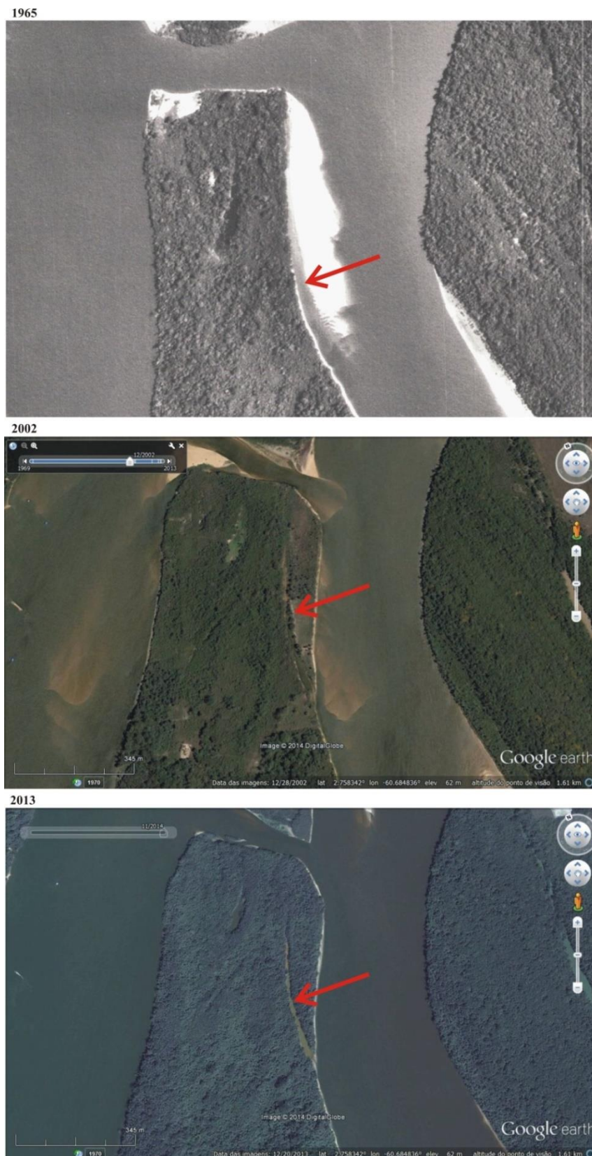
Figura 5.7: Evolução de processo de acreção lateral e formação de lago. A seta vermelha indica a posição do lago formado. Imagens utilizadas: 1965 – USAF-1965; 2002 e 2013 – GeoEye, 2013 (Fonte: Acervo de imagens de Carlos Sander e Thiago M. Carvalho, UFRR)
