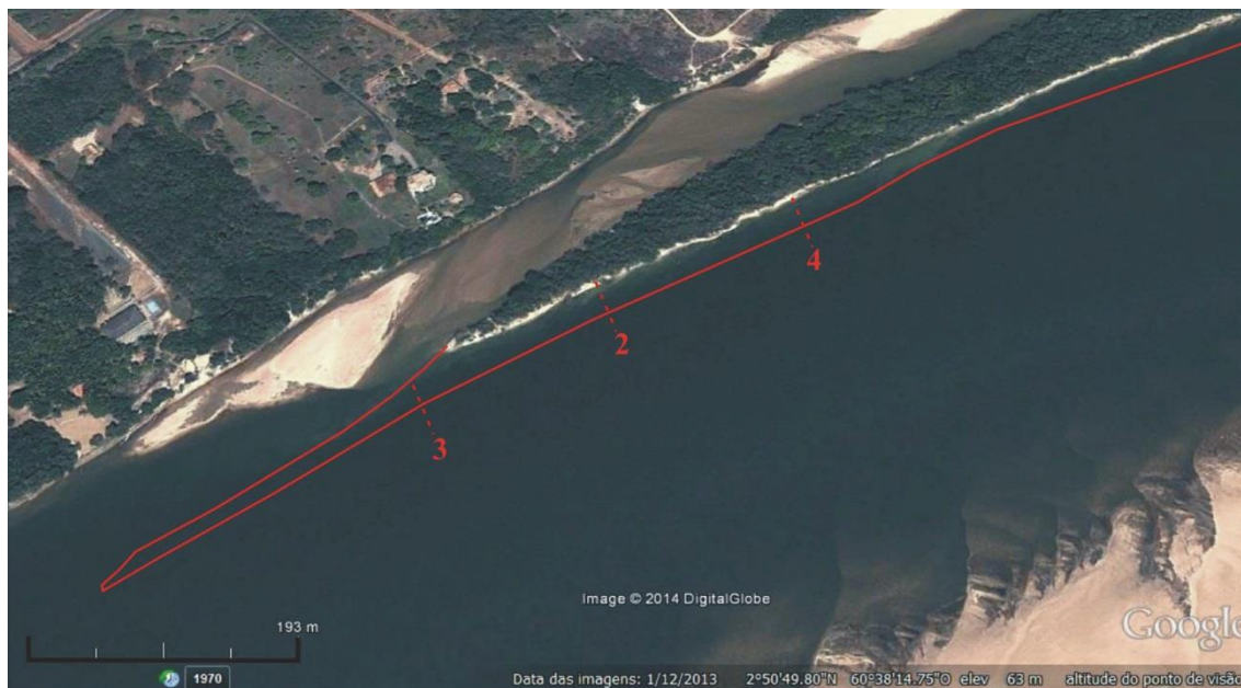
Figura 5.26: Erosão da margem direita do rio Branco na região da confluência com o rio Cauamé entre janeiro de 2003 e janeiro de 2013. Na imagem são mostrados os perfis 2, 3 e 4 (Zona III), onde a linha vermelha mostra o limite do canal no ano de 2003 (Fonte: GeoEye, 2013)
