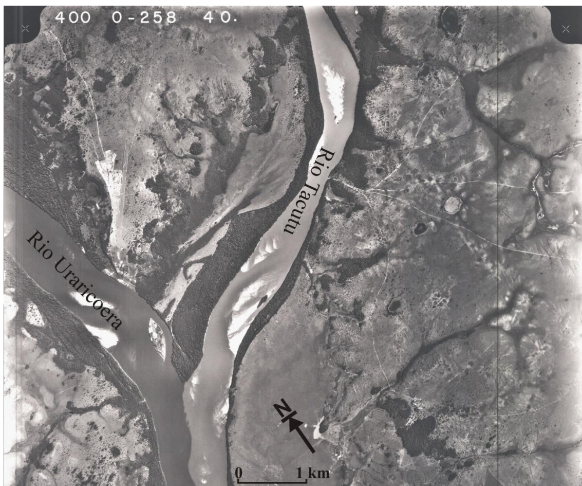
Figura 5.48: Imagem da confluência entre os rios Uraricoera (lado esquerdo) e Tacutu (lado direito) em abril de 2013, onde tem início o canal do rio Branco. Na imagem pode ser observada a coloração diferenciada devido ao maior volume de carga em suspensão transportado pelo rio Tacutu (Fonte: GeoEye, 2014)
