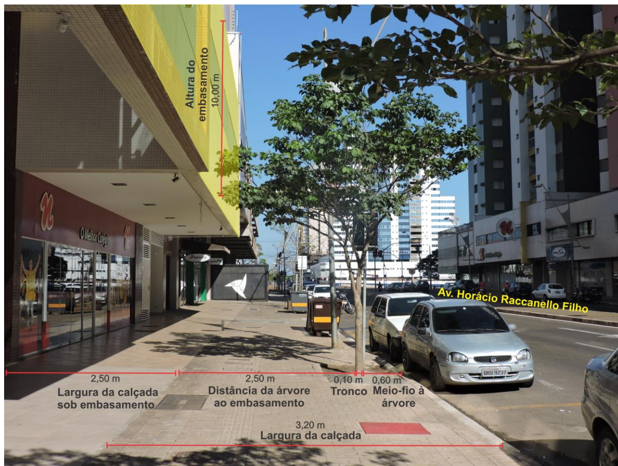
Figura 121. Perfil do embasamento predial e potencial de conflito com arborização viária. Elaboração Ricardo Massulo Albertin (2016).
