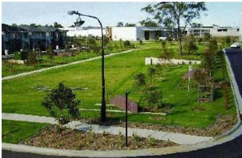
Figura 103 - Exemplo de lagoa pluvial “seca”
