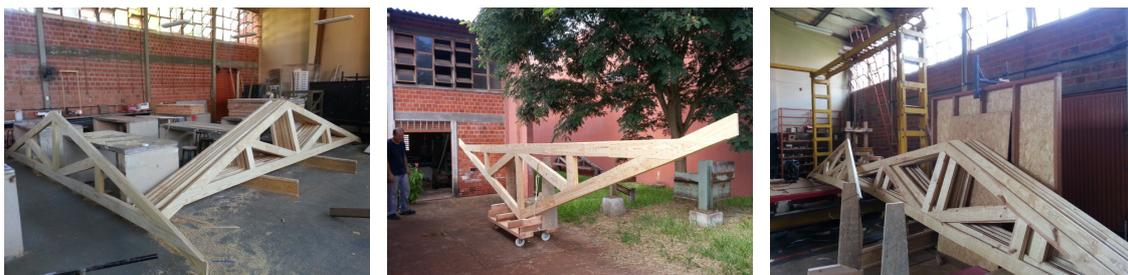
**Figura 63 Fotos dos Caibros treliçados nos laboratórios e carrinho para transporte.**
