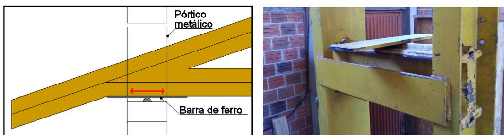
**Figura 65** Croqui e foto do apoio dos caibros treçados no ensaio.
