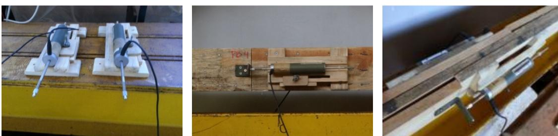
**Figura 37** Fotos dos LVDTs, vista frontal e superior deles instalados nos modelos.
