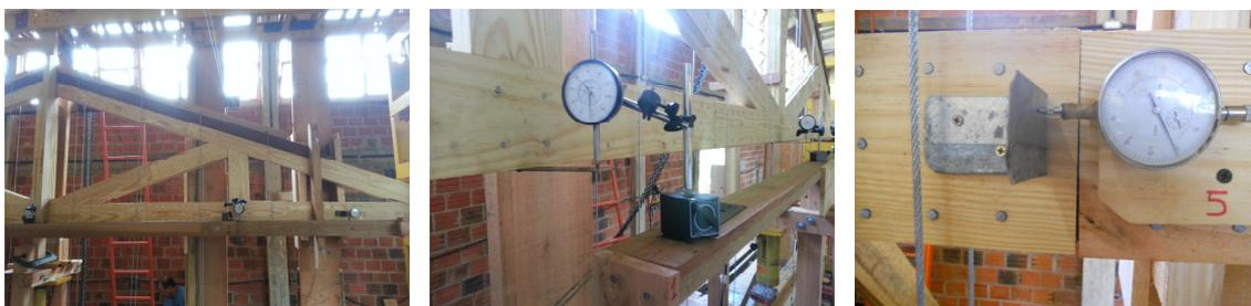
**Figura 68** Fotos dos relógios comparadores instalados.
