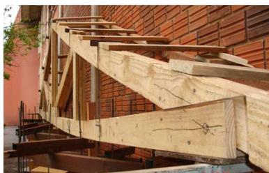
**Figura 16 Foto da tesoura após ruptura.**
