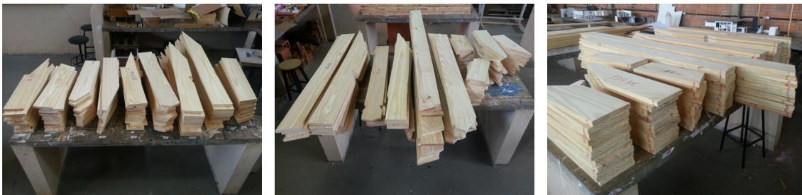
**Figura 57** Fotos das peças organizadas já cortadas no formato final para montagem.
