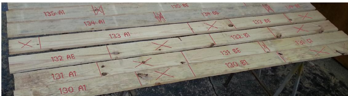
**Figura 49** Peças com as demarcações após a finalização da classificação visual.
