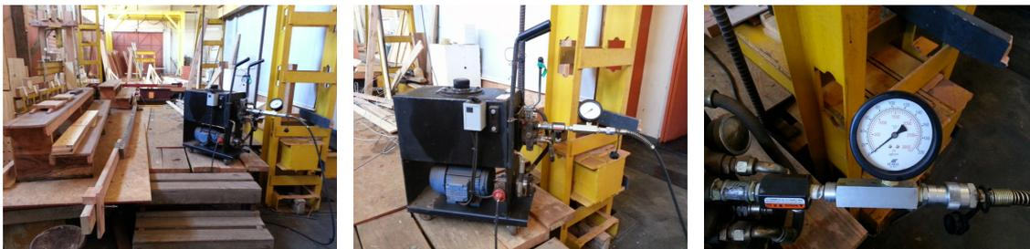
Figura 69 Fotos do local do ensaio, cilindro hidráulico, bomba hidráulica e manômetro.
