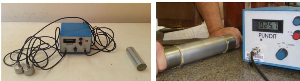
**Figura 51** Processo de calibração do aparelho Pundit 6.
