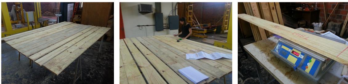
**Figura 46** Fotos das tábuas sobre cavaletes, classificação visual e pesagem das peças.
