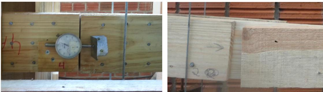
**Figura 84 Fotos da emenda no ensaio de RECCO, 2015 e CADURIN, 2013, respectivamente.
