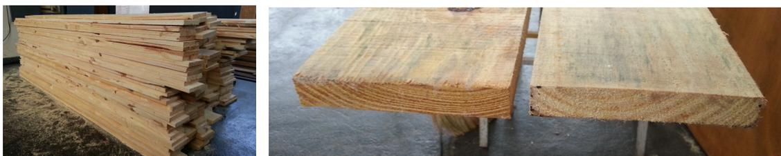
**Figura 42** Fotos das tábuas empilhadas no momento da chegada e diferença da quantidade de anéis.
