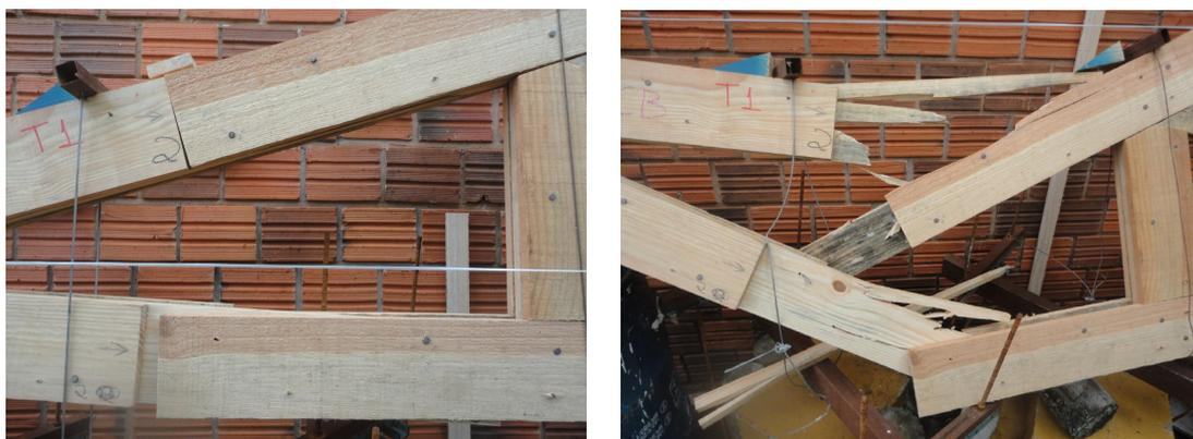
**Figura 21** Deslocamentos das emendas na tesoura após a quinta série de carregamento (13,6 kN) e a estrutura após sua ruptura, respectivamente.
