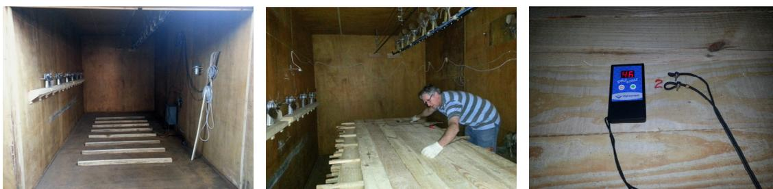
**Figura 45 Foto interna das adaptações da estufa (ventiladores laterais), entablicamento, colocação dos medidores de umidade da madeira e medição da umidade.**
