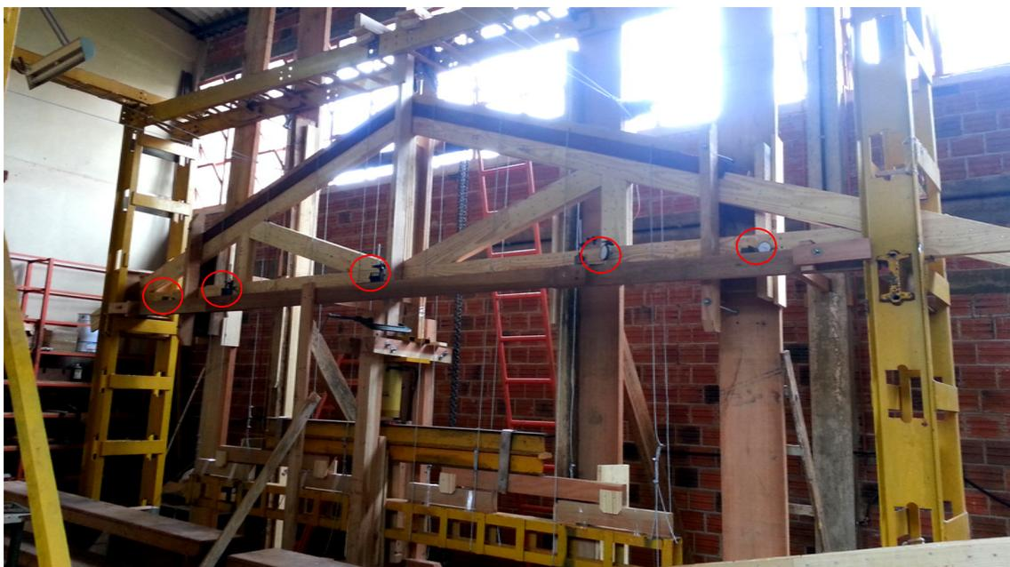
**Figura 67** Foto do Caibro treliçado instrumentalizado para o ensaio. Em destaque a localização dos 5 relógios comparadores.
