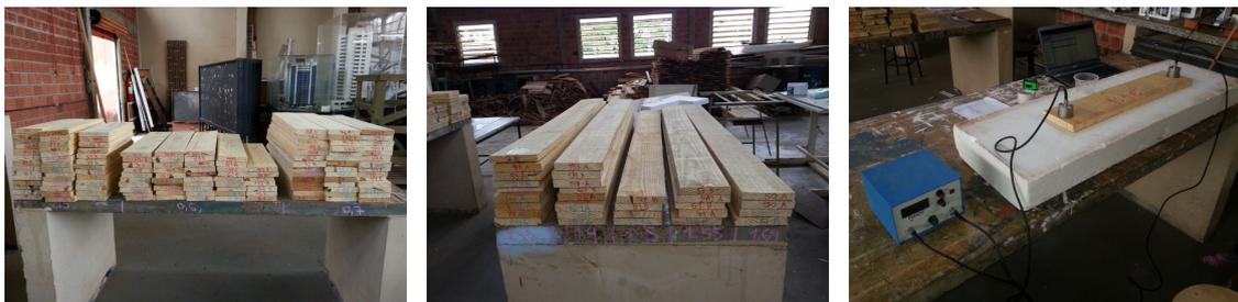
**Figura 52** Fotos das peças agrupadas conforme comprimentos e medição pelo ultrassom.
