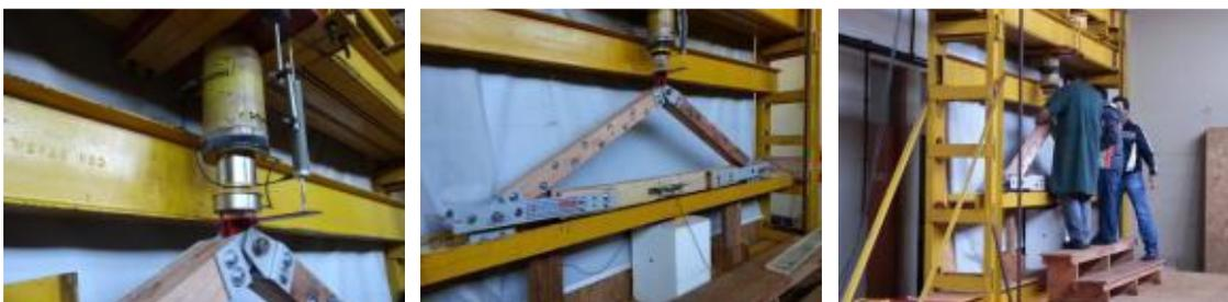
**Figura 36** Foto da célula de carga, pórtico metálico e montagem do aparato.
