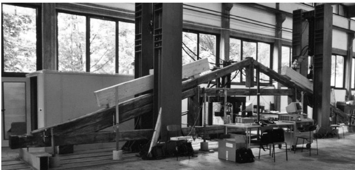
**Figura 29** Esquema de montagem de ensaio com carregamento aplicado de forma simultânea.
