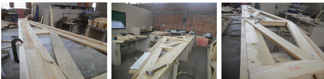
**Figura 62** Fotos do gabarito executado para a execução das 6 amostras.
