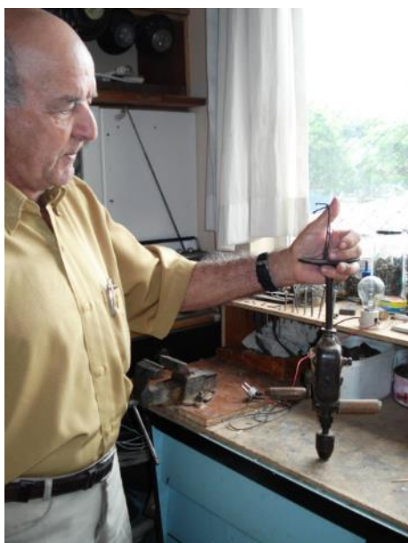
Figura 17 – Fotografia do ex-carpinteiro Sr. Izaltino com um arco-de-pua
